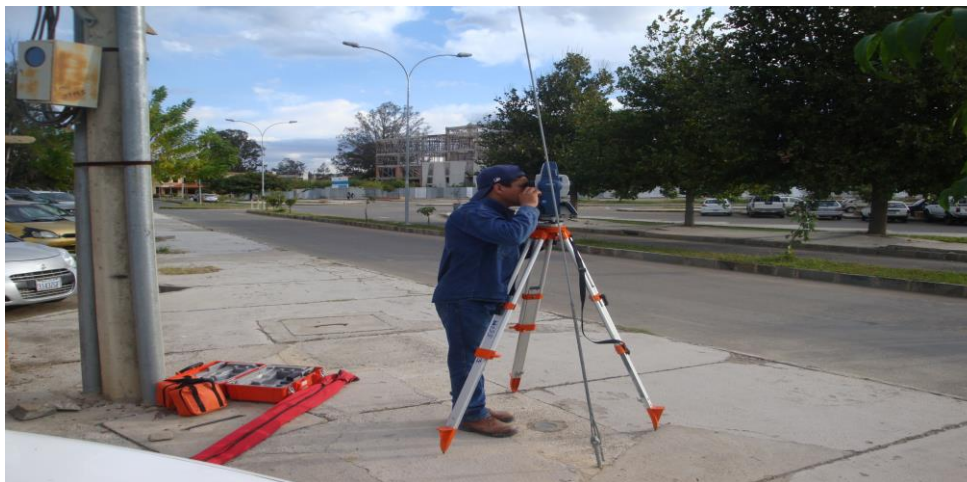
Figura 3.4. Equipo ubicado en el punto PB08, lecturando los puntos de control y realizando el levantamiento de la zona
