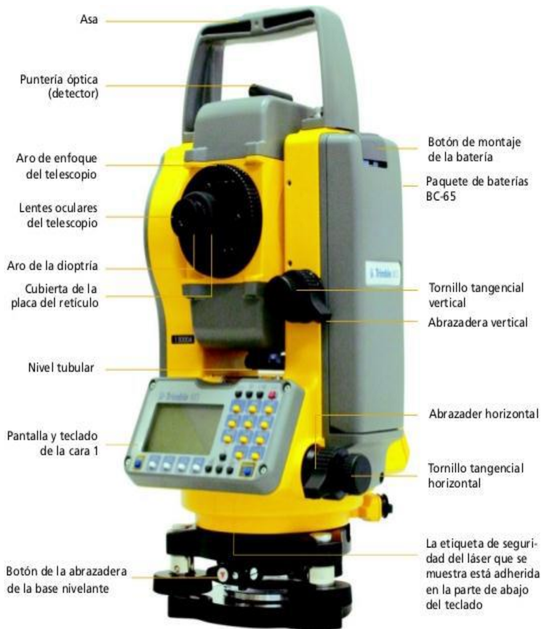
Figura 2.13. Partes de una estación total lado 1
