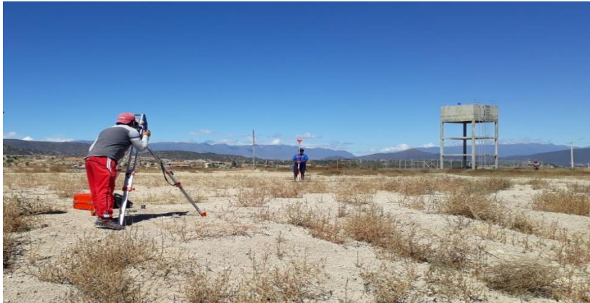
Figura 3.2. Equipo estación total ubicado en el punto E1 y lecturando los 16 puntos de control ubicados en la zona y realizando el levantamiento de superficie
