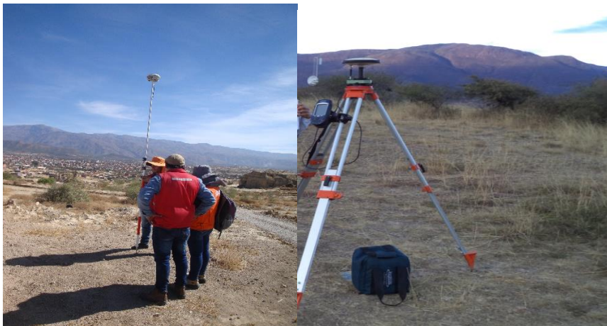
Figura 3.1. Obtención de coordenadas en los puntos de referencia E1, R1 con GPS RTK, con punto base TAR 01
