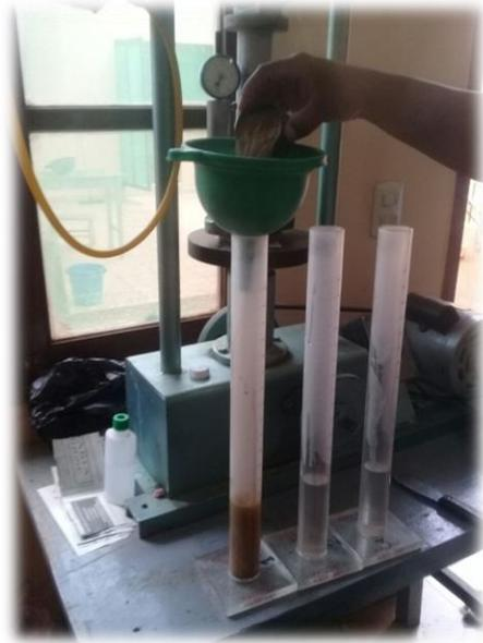
Imagen 3.17 Sedimentando para obtener alturas de arena arcilla
