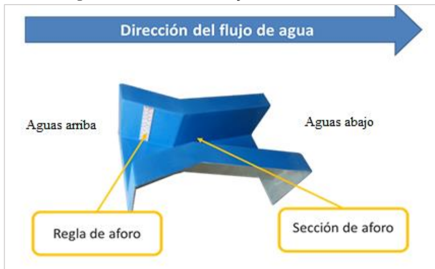
Figura 1.8: Dirección del flujo, aforador Sin Cuello
