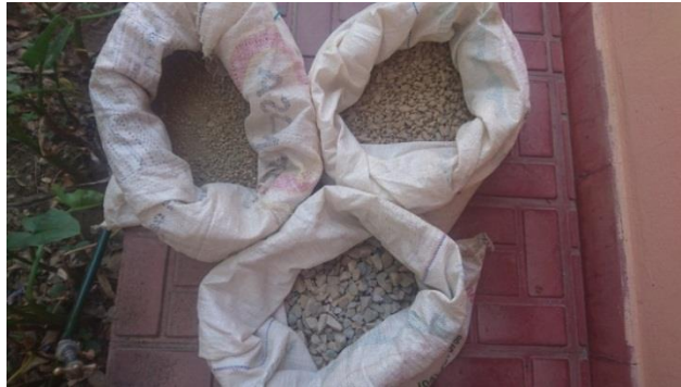
Figura 3. 1: Agregado de 3/4", 3/8" y arena.
