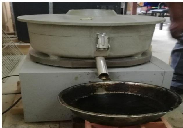
Extractor de reflujo (Método B). - Este método es usado para la determinación cuantitativa del contenido de betumen en las mezclas de pavimentación.
