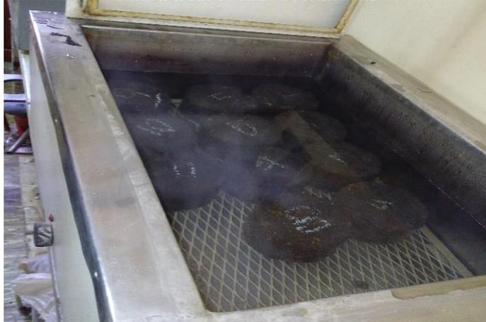
**FIGURA** ¡Error! No hay texto con el estilo especificado en el documento..**57** Colocado de briquetas en aparato Marshall
