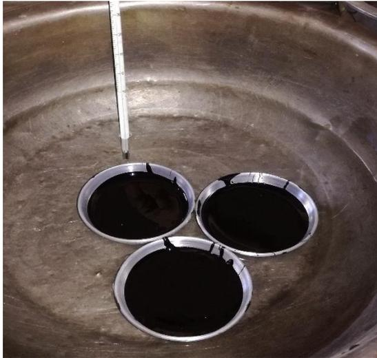
**FIGURA** ¡Error! No hay texto con el estilo especificado en el documento..27 Ensayo de penetración
