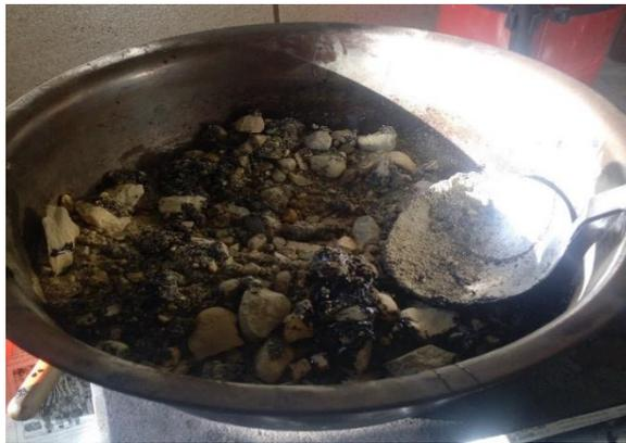
Verter la mezcla en los moldes Marshall, en tres capas, las dos primeras con 25 varillasos para el acomodo y la tercera con 75 golpes con el martillo; dar la vuelta de cara y aplicar otros 75 golpes.
