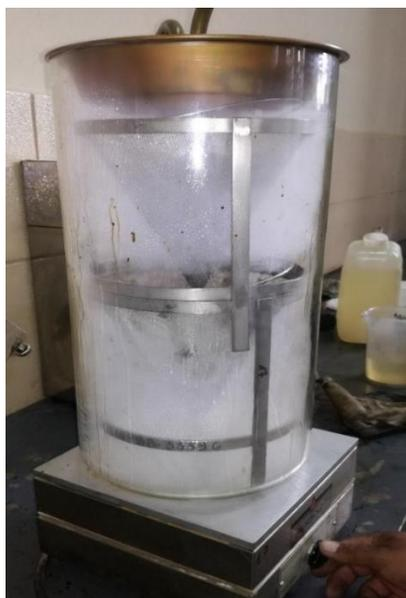
Extractor de vacío (Método E). - Este método es usado para la determinación cuantitativa del contenido de betumen en las mezclas de pavimentación.
