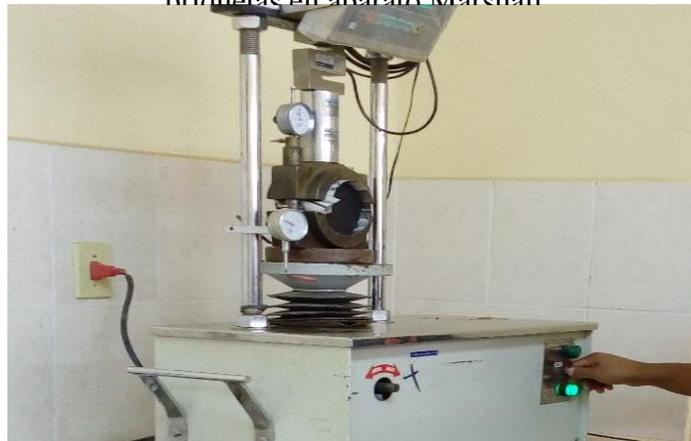
**FIGURA** ¡Error! No hay texto con el estilo especificado en el documento..**58** Lectura del dial de estabilidad (dentro del dial de Marshall) en el dial de deformación en el dial
