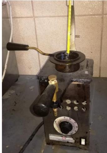
Ductilómetro. - Con el cual se determina la ductilidad del betún, a una temperatura estándar de 25 ° C.
