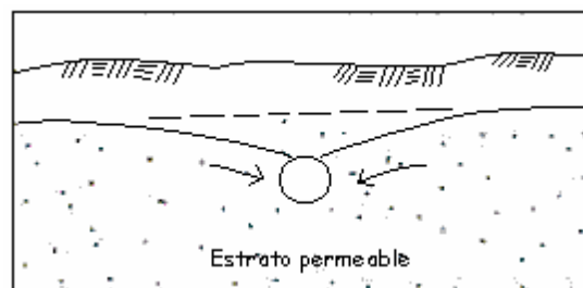
Figura 23: Galería que Comprometen parte la Superior del Acuífero y Ubicada en Acuífero con Escurrimiento Propio
