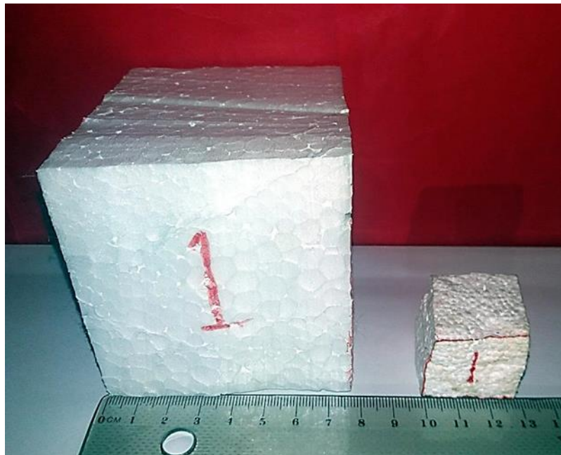
Figura 15) 3.7: Reducción del volumen y aumento del peso específico del EPS. (Fuente: Elaboración Propia)
