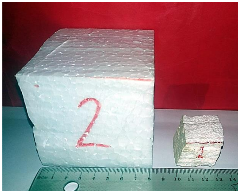
Figura 16) 3.8: Reducción del volumen y aumento del peso específico del EPS. (Fuente: Elaboración Propia)
