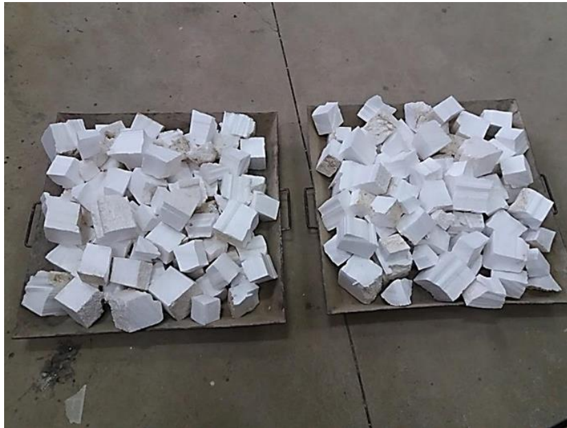
Figura 12) 3.4: Muestra de EPS previo tratamiento térmico. (Fuente: Elaboración Propia)
