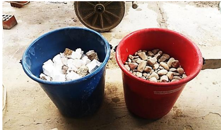
Figura 22) 3.14: Reemplazo volumétrico del agregado grueso de MEPS. (Fuente: Elaboración Propia)
