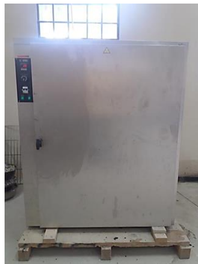
Figura 11) 3.3: Horno eléctrico utilizado para tratar el EPS. (Fuente: Elaboración Propia)
