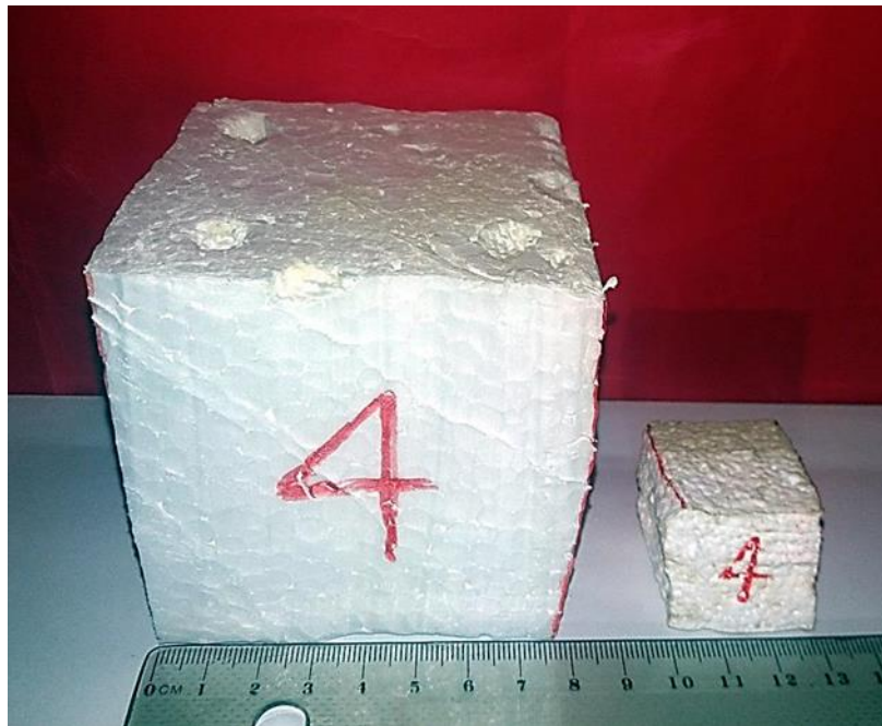
Figura 18) 3.10: Reducción del volumen y aumento del peso específico del EPS. (Fuente: Elaboración Propia)
