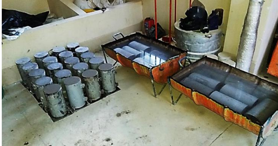
Figura 25) 3.17: Probetas después de su acabado y curado. (Fuente: Elaboración Propia)
