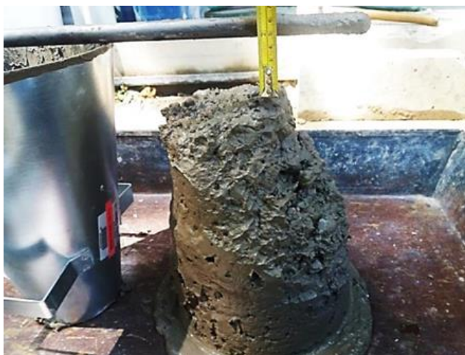
Figura 19) 3.11: Determinación de la docilidad - Cono de Abrams. (Fuente: Elaboración Propia)
