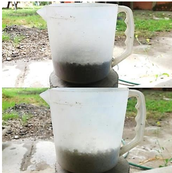
Figura 23) 3.15: Reemplazo volumétrico del agregado fino de MEPS. (Fuente: Elaboración Propia)
