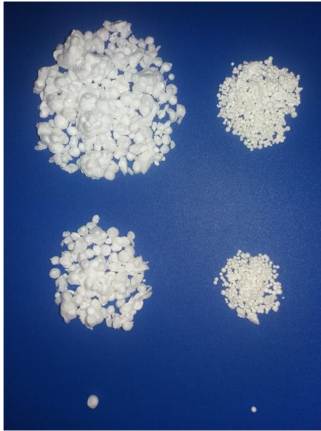
Figura 14) 3.6: Muestra de EPS fino (izq.) y MEPS fino (dcha.) (Fuente: Elaboración Propia)
