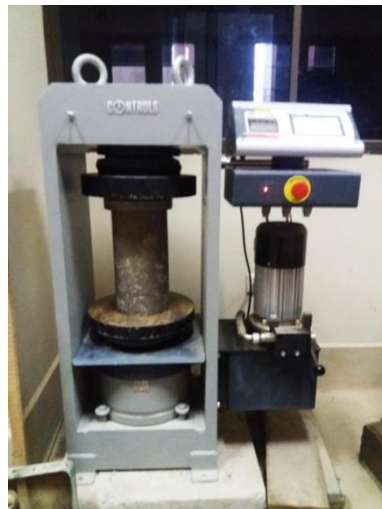
Figura 21) 3.13: Prensa hidráulica para ensayos de compresión. (Fuente: Elaboración Propia)
