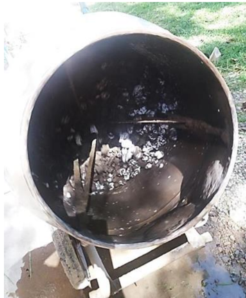
Figura 24) 3.16: Mezcladora utilizada para la dosificación de los hormigones. (Fuente: Elaboración Propia)
