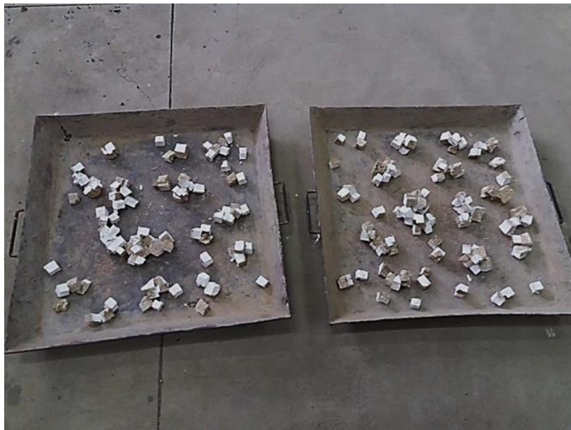
Figura 13) 3.5: Muestra de EPS después del tratamiento térmico. (Fuente: Elaboración Propia)
