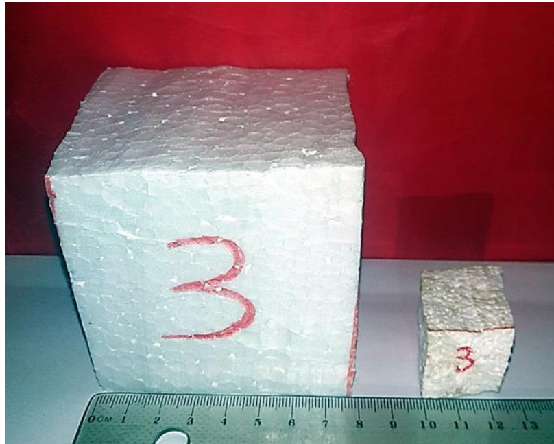
Figura 17) 3.9: Reducción del volumen y aumento del peso específico del EPS. (Fuente: Elaboración Propia)
