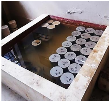
Figura 20) 3.12: Curado de probetas. (Fuente: Elaboración Propia)
