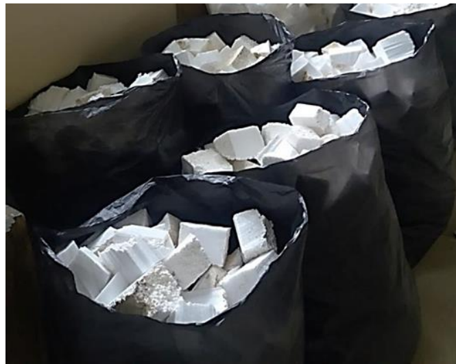
Figura 9) 3.1: EPS recolectado para la elaboración de MEPS. (Fuente: Elaboración Propia)
