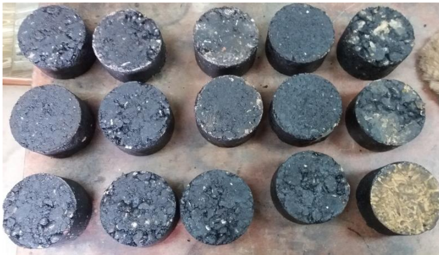
Figura N°30. Briquetas después de compactarse 75 golpes por cara.
