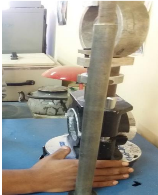
Figura N°31. Ensayo de estabilidad y fluencia.
