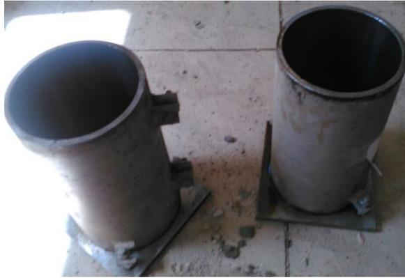
*FOTOGRAFÍA 3.8: Moldes para la elaboración de probetas
