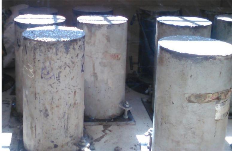
*FOTOGRAFÍA 3.13: Probetas desmoldadas de hormigón
