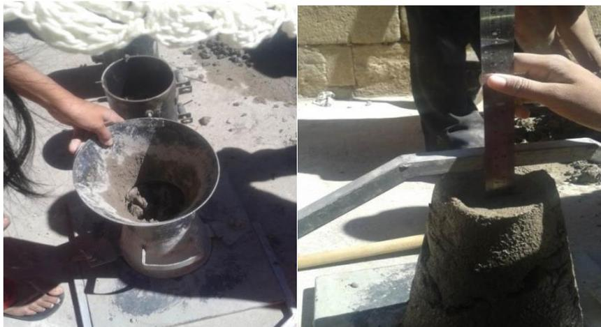
*FOTOGRAFÍA 3.10: Verificación del asentamiento de la masa de hormigón
