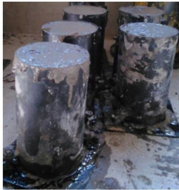
*FOTOGRAFÍA 3.12: Moldes cilíndricos con mezcla de hormigón
