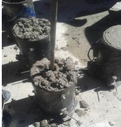
*FOTOGRAFÍA 3.11: Compactado con la varilla la mezcla de hormigón
