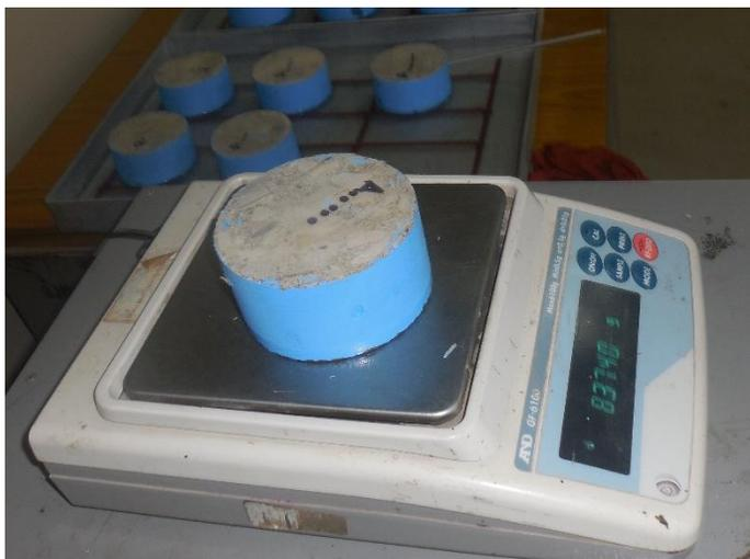
*FOTOGRAFÍA 3.24: Peso del espécimen al inicio del ensayo de Sorptividad*
