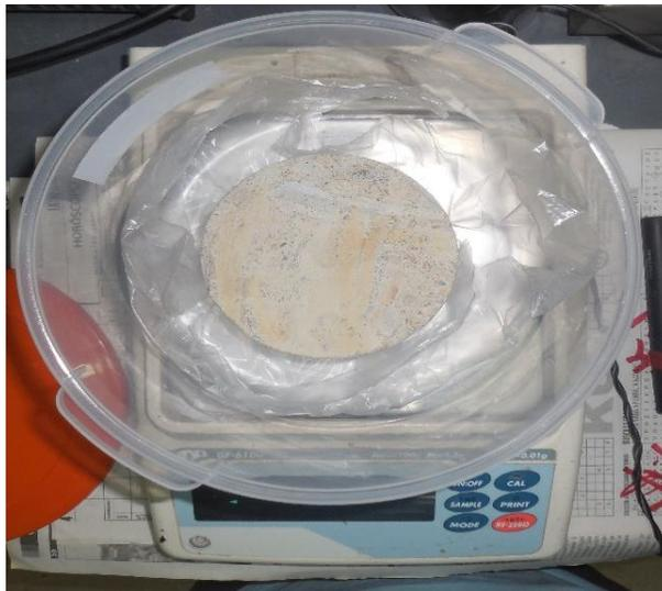
*FOTOGRAFÍA 3.20: Peso de la muestra dentro de un envase sellado
