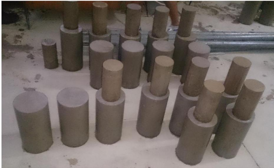
*FOTOGRAFÍA 3.14: Probetas inmediatamente después del curado*
