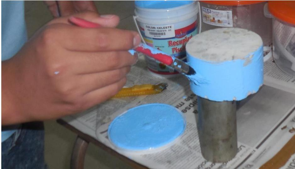
*FOTOGRAFÍA 3.23: Sellado con pintura epóxica recuplast piscina alrededor del espécimen
