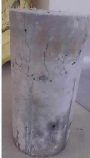
*FOTOGRAFÍA 3.16: Fisuras de rotura de probeta a los 7 días cantera el Rancho.
