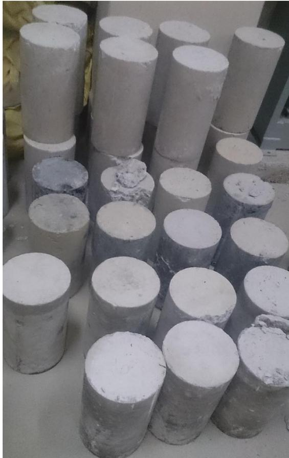
*FOTOGRAFÍA 3.18: Probetas sometidas a rotura a los 28 días; Temporal, Rancho y Camacho*
