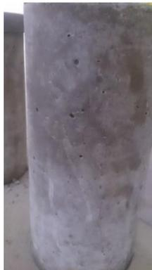
*FOTOGRAFÍA 3.17: Fisuras de rotura de probeta a los 28 días de la cantera de Camacho
