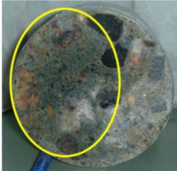
*FOTOGRAFIA 2.1: Fuga de agua entre la cinta y el espécimen
