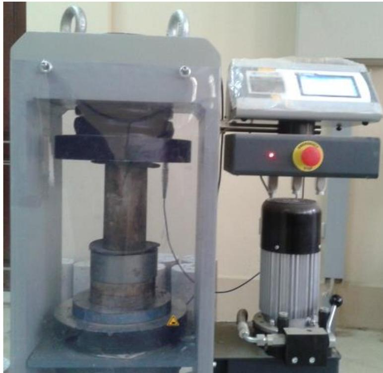
*FOTOGRAFÍA 3.15: Prensa para rotura de probetas.*
