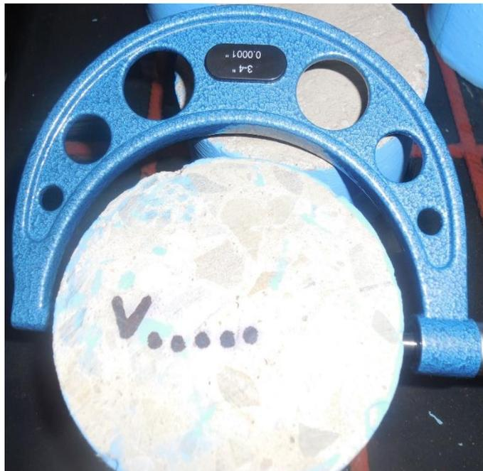
*FOTOGRAFÍA 3.22: Medición del diámetro del espécimen
