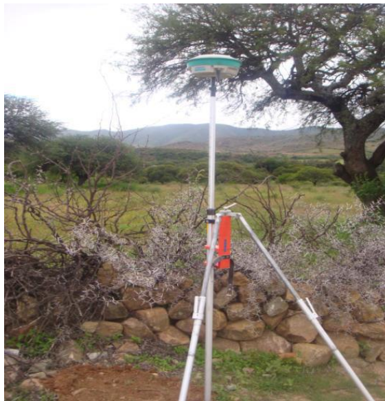
Figura N° 1 Equipo GPS Estático de Doble Frecuencia
