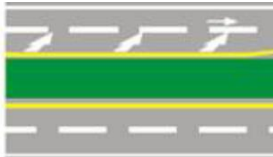
Figura 2.14. Demarcación de calzadas.
