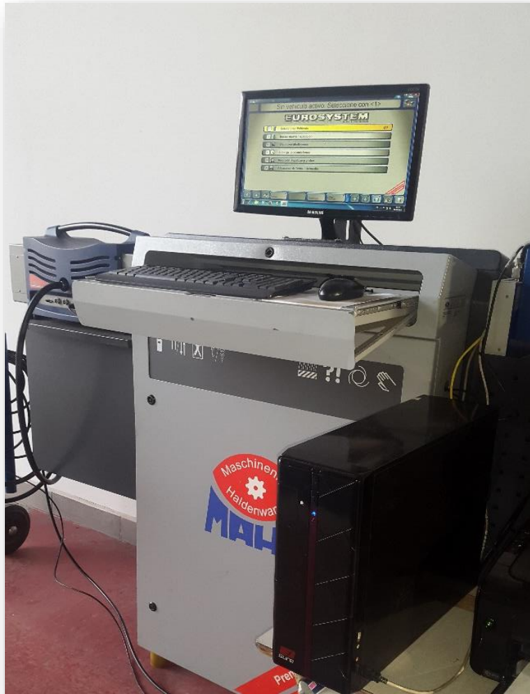
FIGURA N° 24 PC con el software EUROSYSYSTEM, conectada al opacímetro y sondas de medición todos estos equipos marca MAHA
