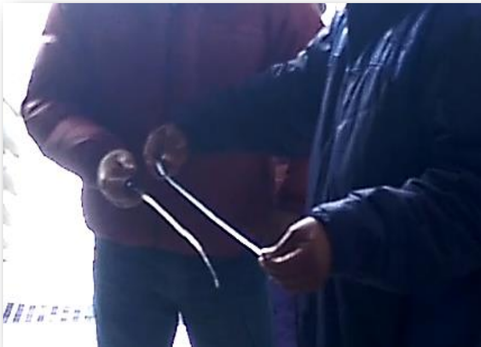
FIGURA N° 26 Medición de la varilla del aceite para introducir la sonda de temperatura con el mismo tamaño
