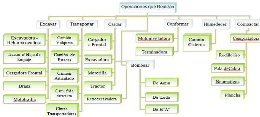
FIGURA N° 6 Clasificación de la maquinaria pesada según las operaciones que realizan
