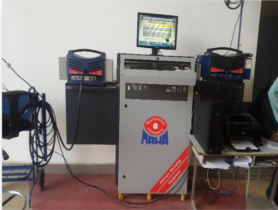
FIGURA N° 25 Analizador de gases de escape instalado con todos sus accesorios y equipos complementarios.
