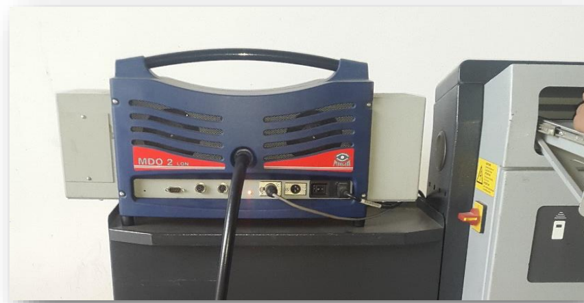
FIGURA N° 23 Equipo analizador de gases MDO2 conectado a la sonda de humos, temperatura de aceite y equipo de medición de revoluciones RPM 100
