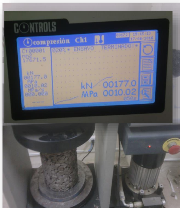
Figura 12. Ensayo rupturas de probetas de pavimento drenante con la prensa hidráulica y su respectiva pantalla digital de resultados.
