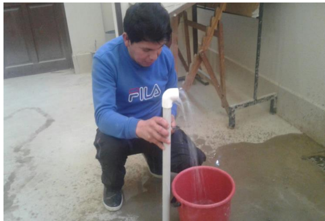
Figura 17. En la figura se muestra el equipo completo a poner en funcionamiento. Un permeámetro de carga constante funciona poniendo una carga de agua sobre la muestra y aforando con un recipiente graduado el agua escurrida.
