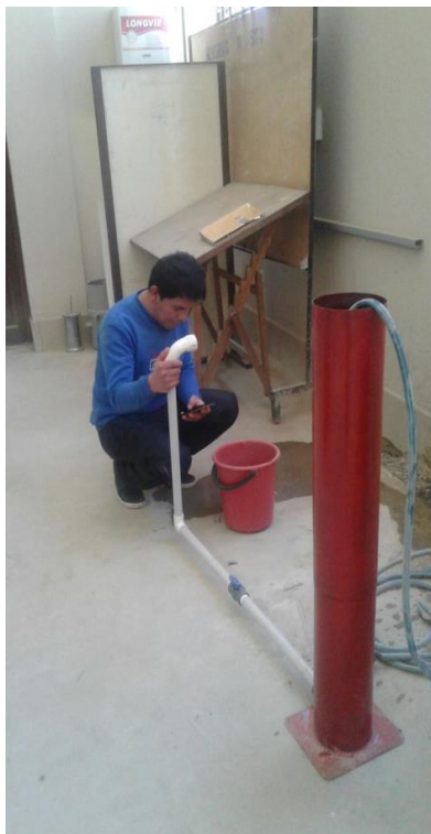
Figura 17. En la figura se muestra el equipo completo a poner en funcionamiento. Un permeámetro de carga constante funciona poniendo una carga de agua sobre la muestra y aforando con un recipiente graduado el agua escurrida.
