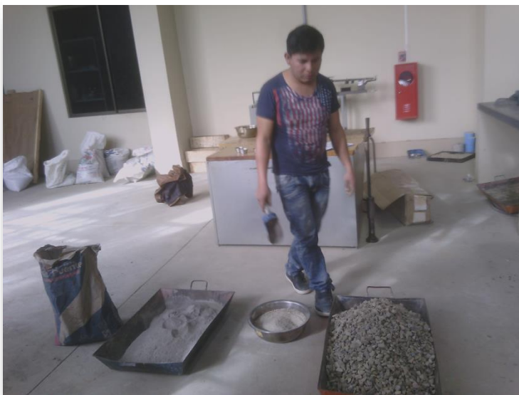
Figura 10. Una vez dosificada la mezcla preparamos los agregados para un determinado número de moldes, tanto como vigas para la ruptura a flexión y probetas para la ruptura a compresión.
