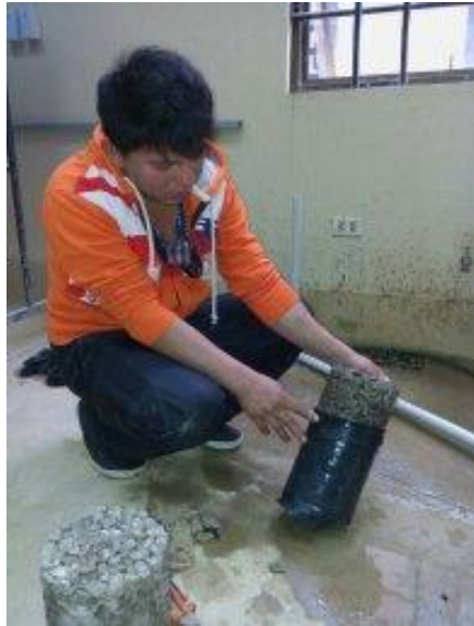
Figura 15. Para realizar el ensayo de permeabilidad se impermeabilizo el perímetro de la muestra.
