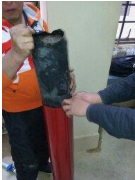
Figura 16. Cuando se introduce la muestra al equipo de permeabilidad se tiene que tener mucho cuidado que el agua no escurra por su perímetro.
