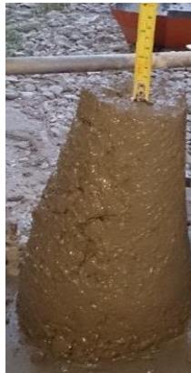
Fotografía N°3. Hormigón fresco, ensayo del cono de Abrams.
