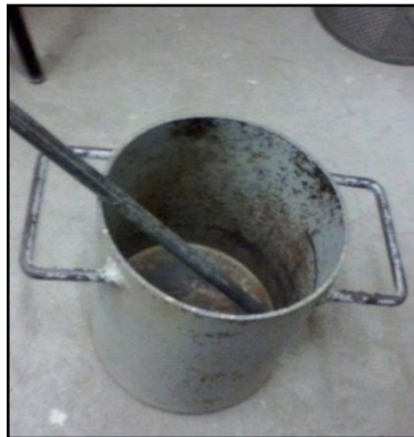
Fotografía N° 25. Equipo para peso unitario de la arena (3 litros).
