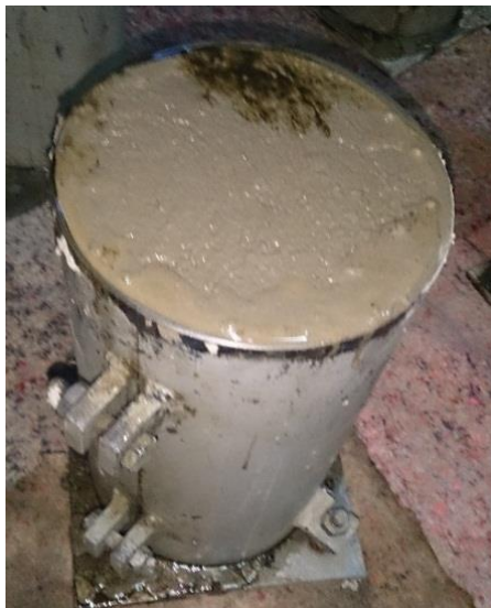
Fotografía N°2 hormigón fresco en un molde.
