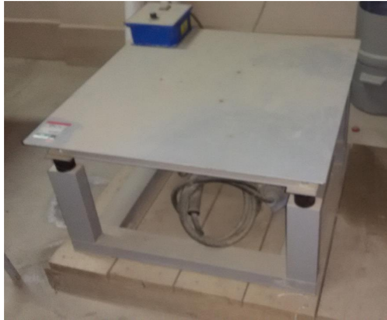
Fotografía N°29. Equipo usado para realizar el vibrado de los moldes cilíndricos
