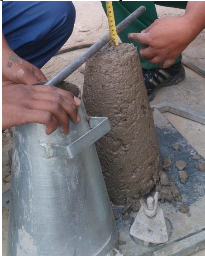
Fotografía N° 28. Ensayo de cono de Abrams.
