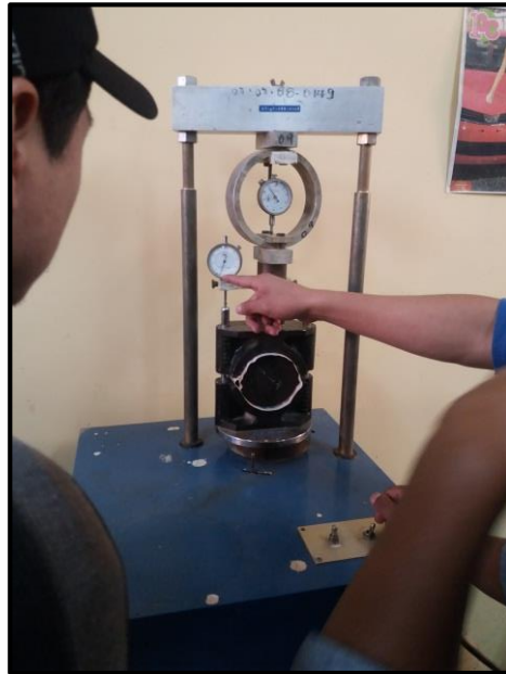
Figura 3.24 Mediciones de estabilidad y fluencia a las probetas asfálticas
