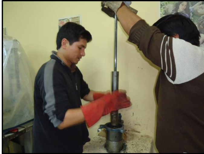
Figura 3.23 Compactación con el martillo Marshall
