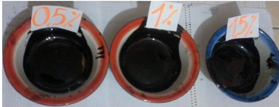
Imagen 3.62: Cemento asfáltico modificado con 0,5%, 1%, y 1,5% con ácido fosfórico
