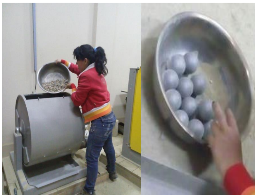
Imagen 3.8: Introducir la muestra y las cargas abrasivas En la Máquina de Los Ángeles
