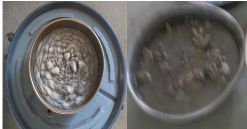
Imagen 3.10: Tamizar la muestra por los tamices N°8 y N°12, para luego lavar y dejar al horno a secar y pesar
