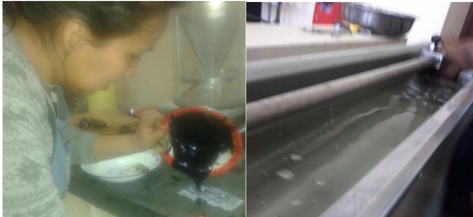
Imagen 3.35: verter el cemento asfáltico en los moldes y dejar enfriar Después poner en baño maría
