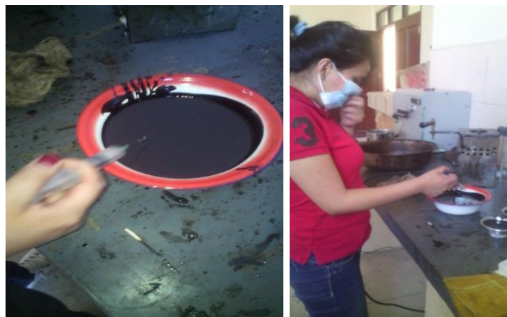
Imagen 3.63: Incorporando el ácido fosfórico en el asfalto, con la ayuda de jeringa
