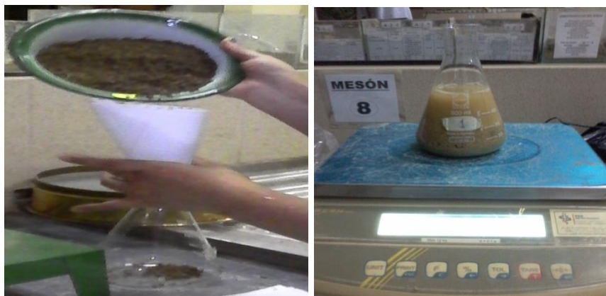
Imagen 3.20: Colocar en un matraz 500gr de material, llenar agua y pesar
