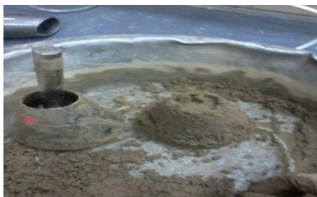
Imagen 3.19: Verificación de la condición muestra Saturada con superficie seca.
