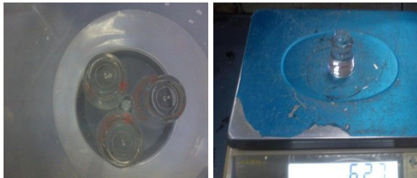
Imagen 3.44: Calibrar y luego pesar cada uno de los picnómetros
