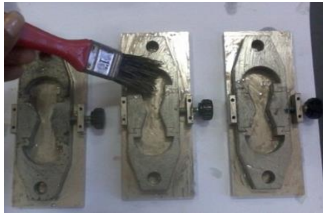
Imagen 3.34: Armado y engrasado de los platos de base y los moldes
