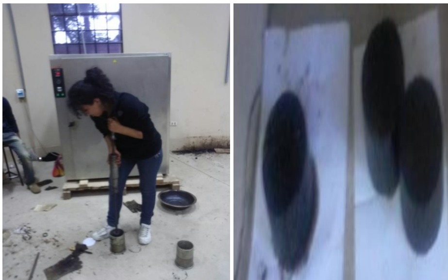
Imagen 3.56: Compactar con 75 golpes cada lado, desmoldar y dejar enfriar
