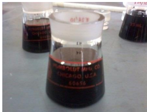
Imagen 3.45: Verter el cemento asfáltico en los picnómetros
