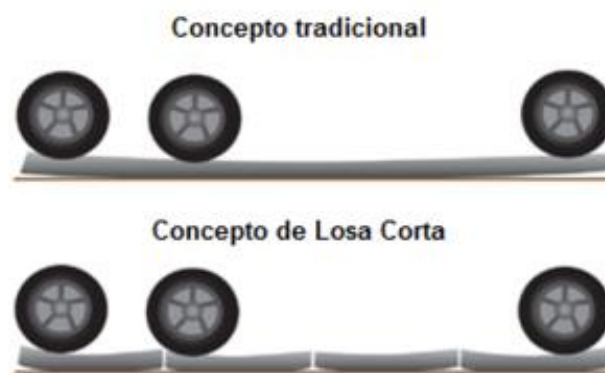
Figura 2.3. Comparación de tipos de losas mediante la posición de las cargas
