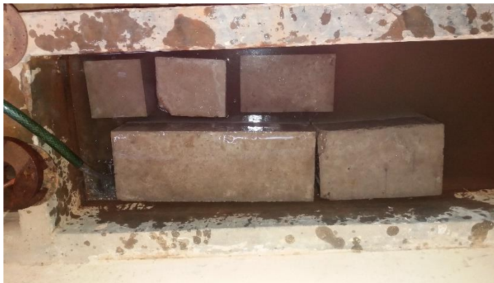
Figura 4.32. Curado de las losas
