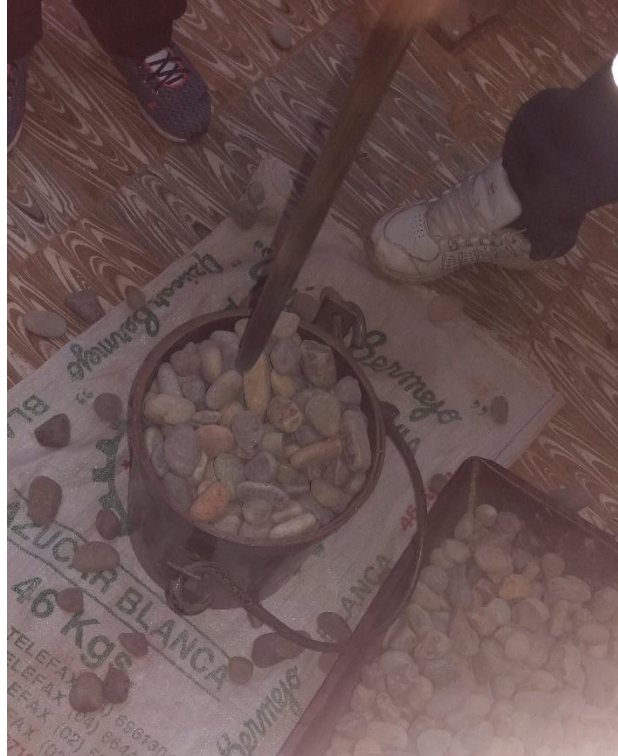
Figura 4.14. Varillado con la barra metálica
