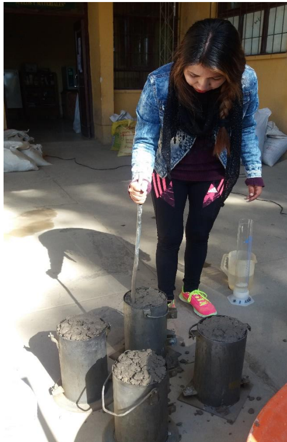
Figura 4.23. Varillado al hormigón
