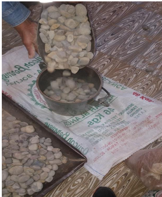
Figura 4.12. Llenado del molde con agregado
