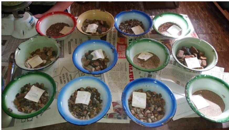
Figura 4.21. Agregados secados en el horno
