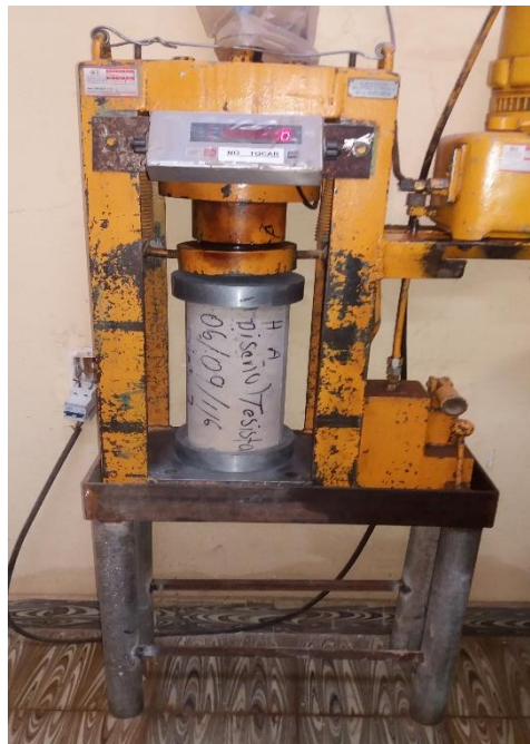
Figura 4.27. Probeta en la prensa
