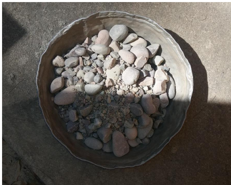
Figura 4.20. Pesaje de la muestra retenida en el tamiz N°12
