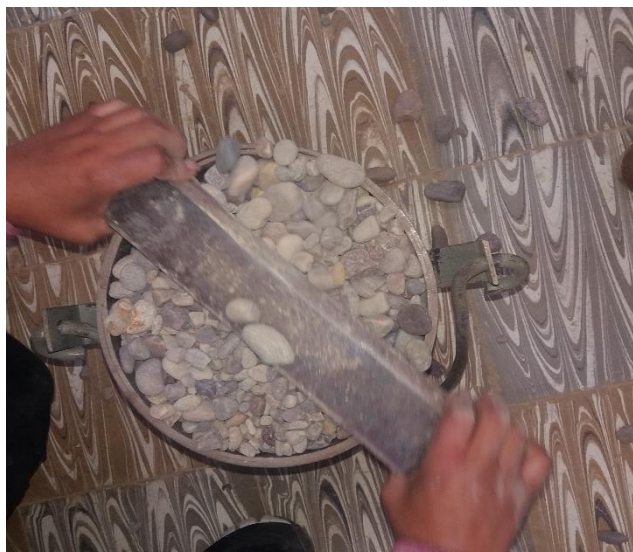
Figura 4.15. Enrazado con la barra apoyada en el borde del molde.
