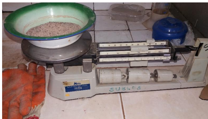
Figura 4.8. Pesaje muestra lavado y secado.
