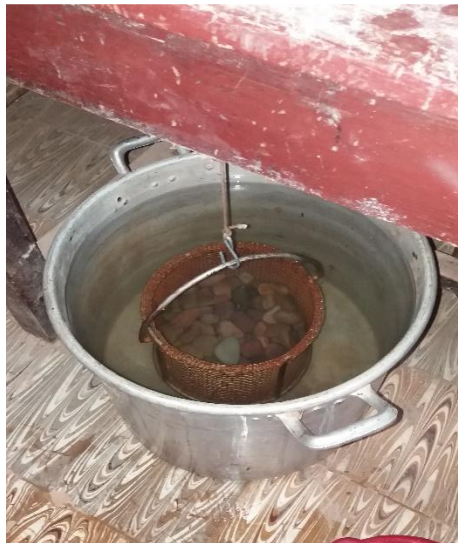
Figura 4.6. Peso muestra sumergido.
