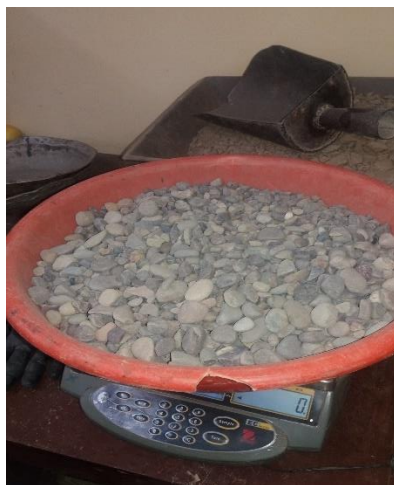
Figura 4.13. Peso del agregado suelto
