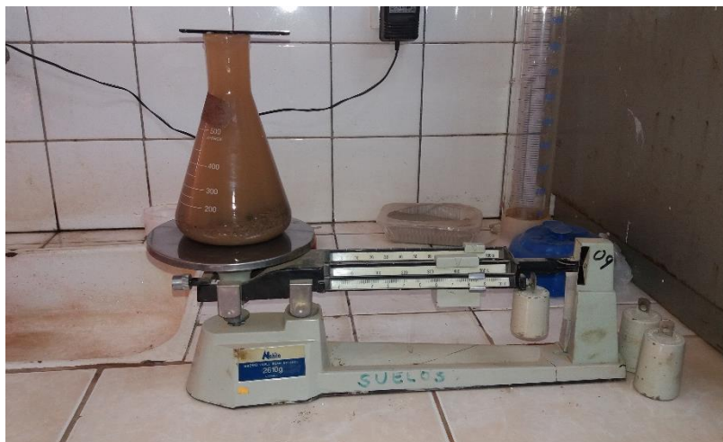
Figura 4.11. Peso de la muestra más agua
