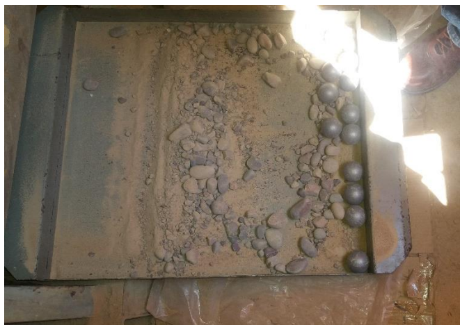
Figura 4.19. Muestra después del ensayo en la máquina de los ángeles.
