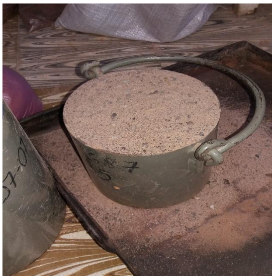
Figura 4.17. Molde llenado hasta la tercera parte de su capacidad
