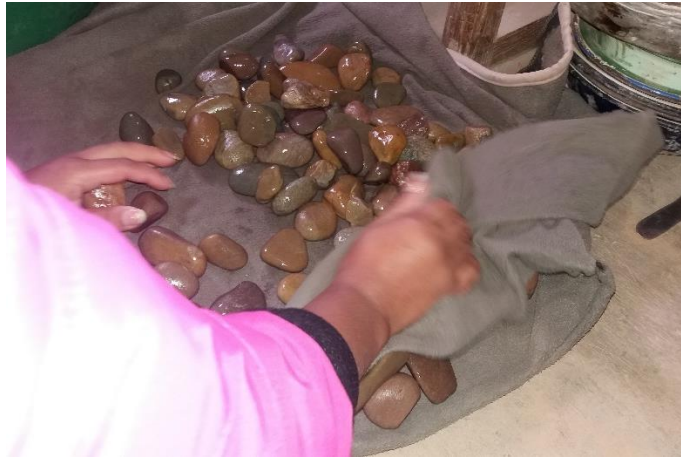
Figura 4.5. Secado superficial de la muestra saturada 24 hrs antes.
