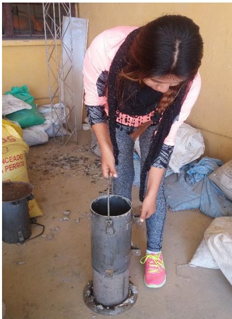
Figura 4.25. Desmolde de las probetas
