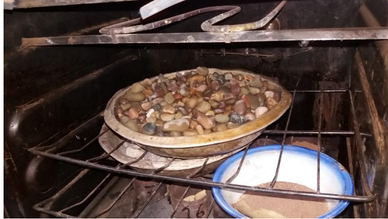
Figura 4.7. Secado de la muestra en horno
