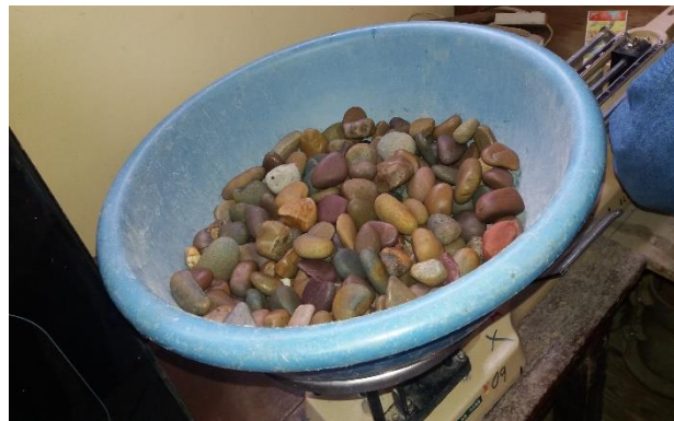
Figura 4.4. Pesaje del material retenido en el tamiz N° 4
