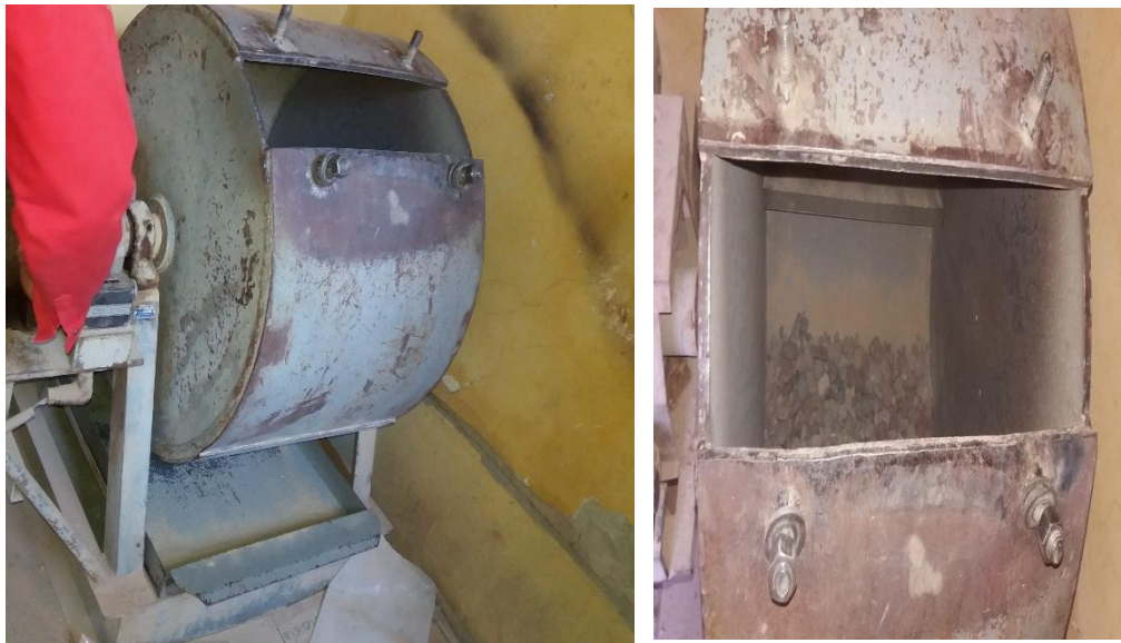
Figura 4.18. Colocado de la muestra en la máquina de los ángeles con el N° de esferas correspondiente.
