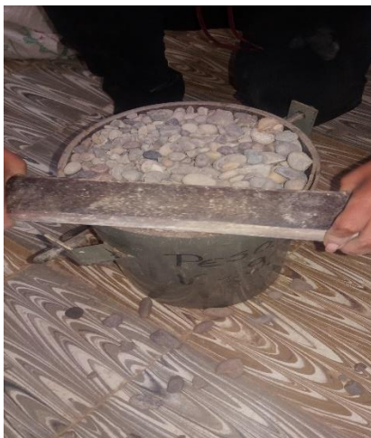
Figura 4.12. Enrazado con la regla metálica
