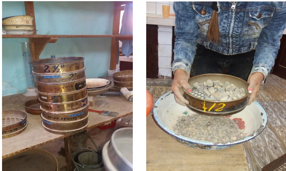
Figura 4.3. Tamizado manual por la serie de tamices.
