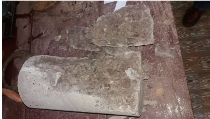
Figura 4.28. Rotura de la probeta a los 28 días.
