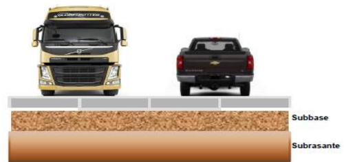
Pavimento Losa Corta
