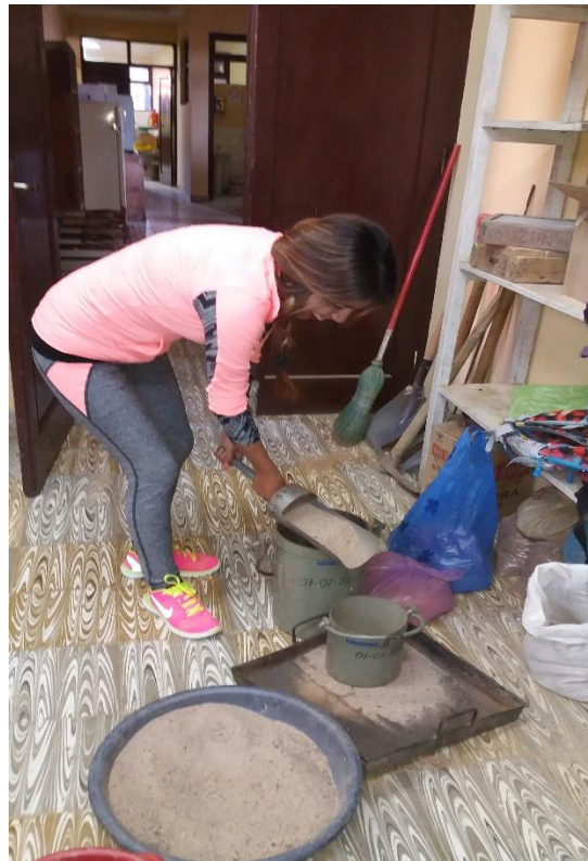
Figura 4.16. Llenado del agregado en el molde
