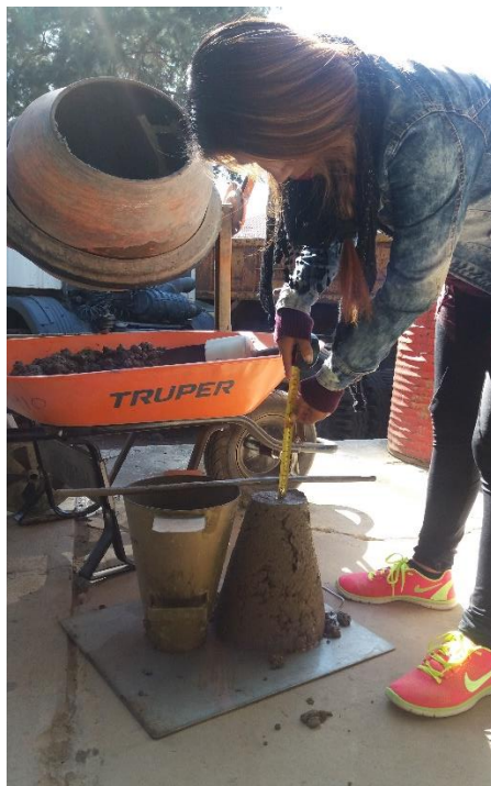
Grafico 4.22. Realizando la medición del Slump
