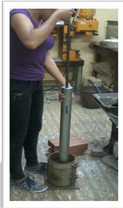
Figura 3.40 Compactando el material granular
