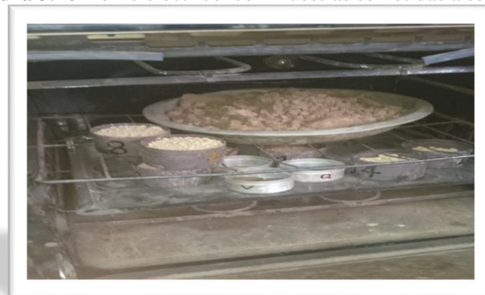
Figura 3.26 Horno eléctrico con muestras sometidas a secado
