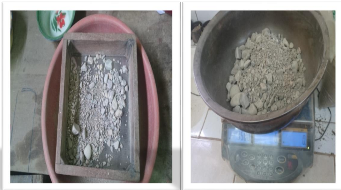
Figura 3.36 Tamizado de la muestra después del sacado de la Maquina de los Ángeles
