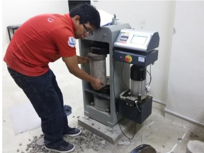
Fotografía 23: Rotura de especímenes
