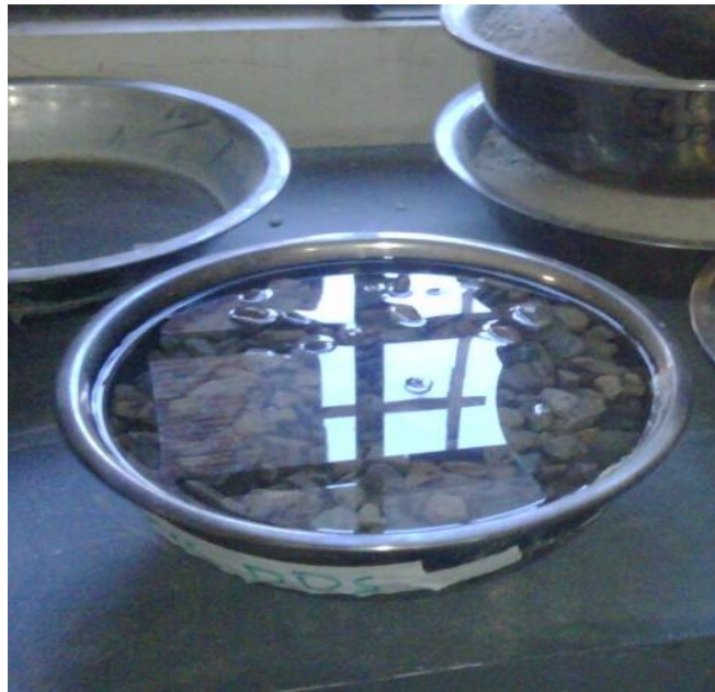
Fotografía 9: Agregado grueso sumergido
