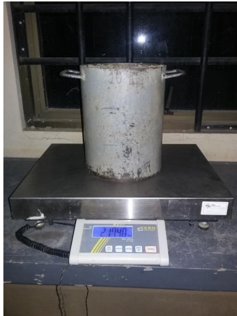
Fotografía 12: Molde Cilíndrico de 10 Lts. de volumen
