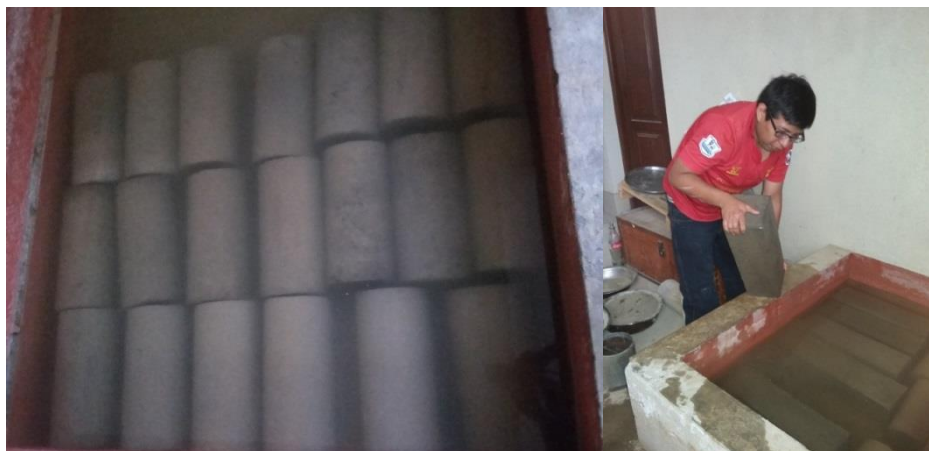
Fotografía 22: Curado de probetas y vigas
