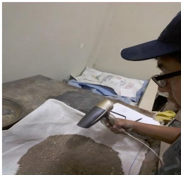
Fotografía 16: Secado de la Arena
