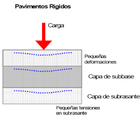
Figura 6: Pavimento rígido sometido a una carga
