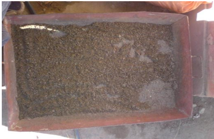
Fotografía 14: Cuarteo de Arena para Granulometría
