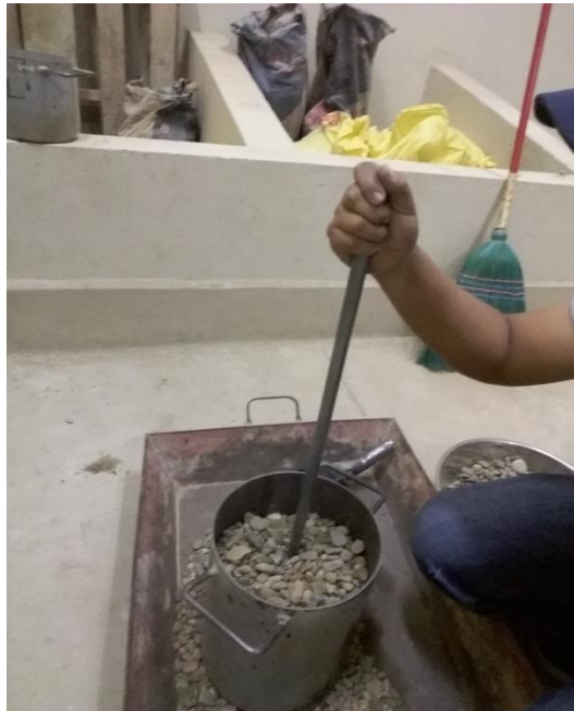
Fotografía 13: Molde cilíndrico con muestra compactada
