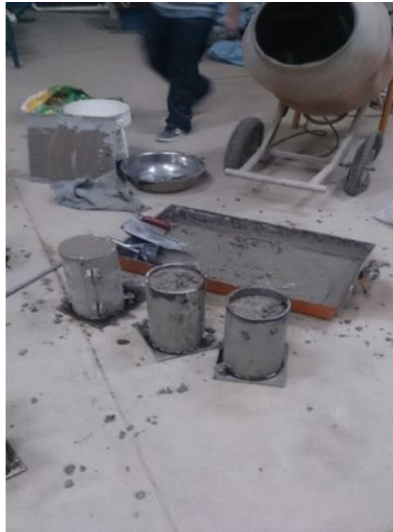
Fotografía 21: Vaciado de probetas
