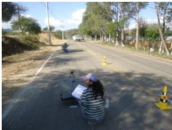
PCI, se realizó un listado con sus respectivas progresivas para poderlas identificar y realizar el ensayo del péndulo, los materiales utilizados para realizar el ensayo son los siguientes; Péndulo Británico, Termómetro, Envase de agua, brocha y una regla calibrada, seguidamente nos trasladamos al lugar de proyecto donde se identificó la
