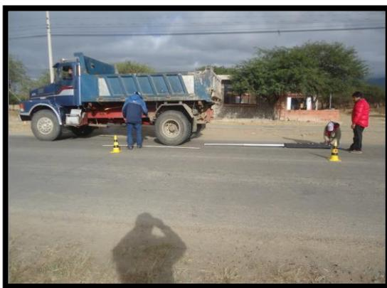
**Procedimiento del ensayo de Viga Benkelman**
