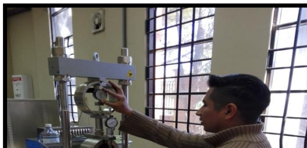
Imagen 4.14: Hacer correr y lecturar el dial de Estabilidad (dentro del anillo Marshall) y el dial de deformación para el Flujo.
