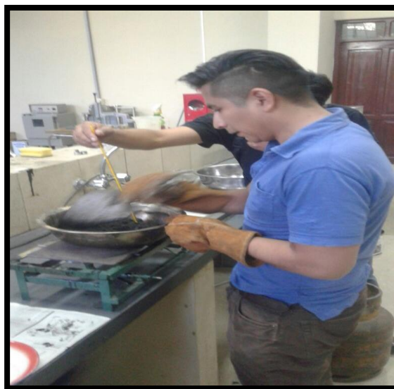
Imagen 4.27: Mezcla asfáltica añadiendo PET controlando la temperatura que no sea mayor a 140°C
