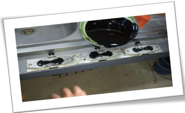
Imagen A.25: Colocado de la muestra en moldes ductilímetro a 25°C
