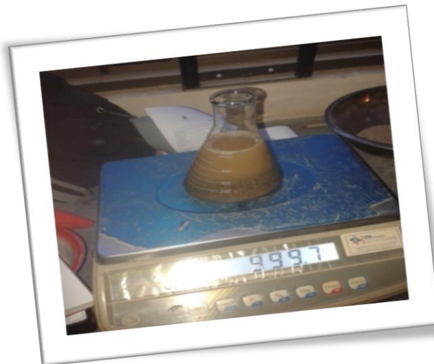
Imagen A.11: Peso de la muestra seca.
