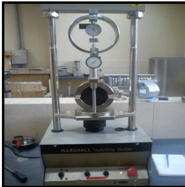
Imagen 4.14: Hacer correr y lecturar el dial de Estabilidad (dentro del anillo Marshall) y el dial de deformación para el Flujo.
