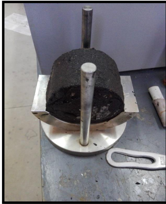
Imagen 4.28: Rompimiento de la Briqueta
