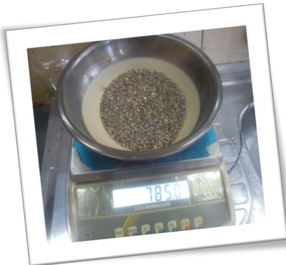
Imagen A.11: Peso de la muestra seca.
