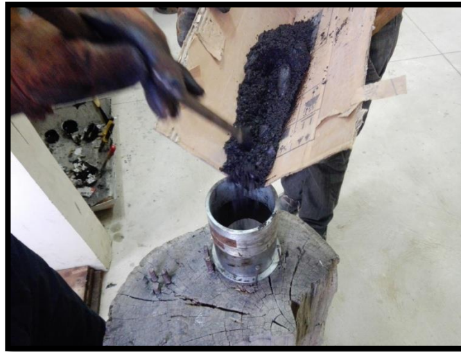
Imagen 4.5: Apizonamiento de la mezcla asfáltica
