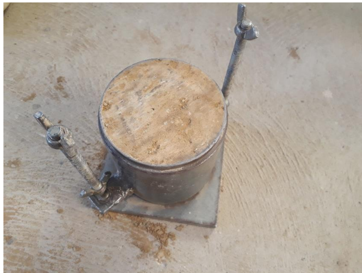
Figura N° 3.17. Ensayo de compactación
