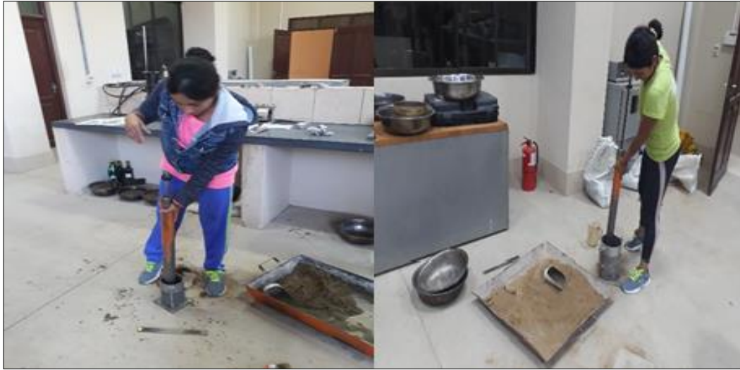
Figura N° 3.16. Ensayo de compactación
