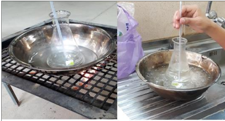
Figura N° 3.5. Ensayo de Calibración del Frasco
