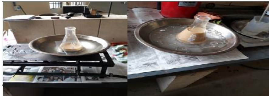
Figura N° 3.7. Ensayo del peso específico de los suelos sometido a baño María caliente y frío
