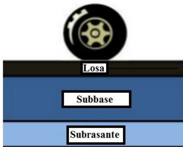
Ilustración 6: CAPAS QUE CONFORMAN EL PAVIMENTO RÍGIDO.
