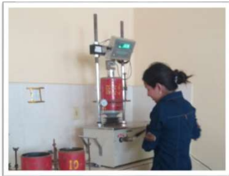
FIGURA 4. 1 ENSAYO DE VALOR SOPORTE CBR
