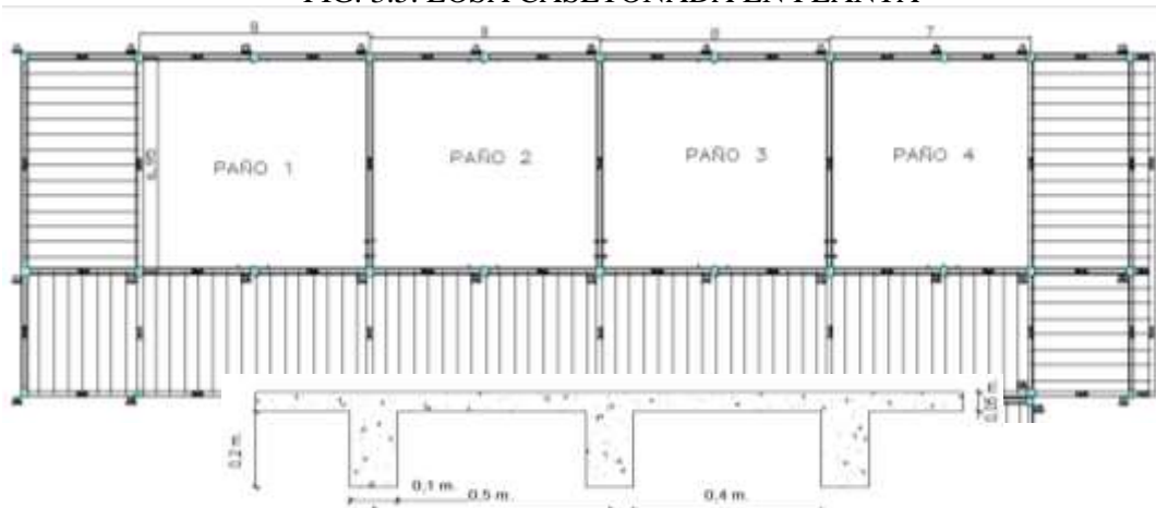
FIG. 3.5. LOSA CASETONADA EN PLANTA
