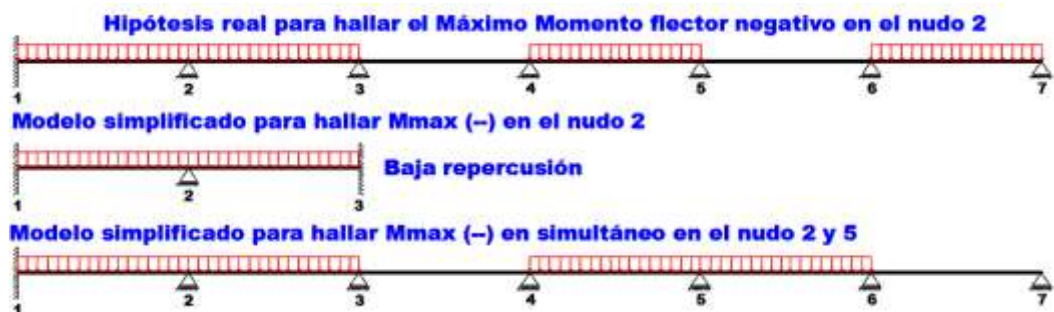
Figura 2.11 Modelos simplificados para obtener el máximo momento negativo
