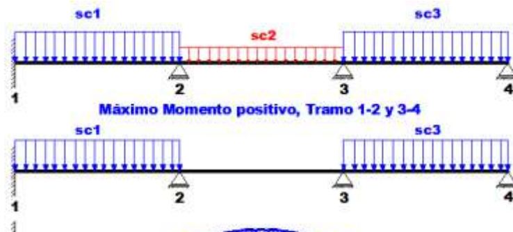
Figura 2.8. Alternación de cargas, para obtener el máximo momento positivo.
