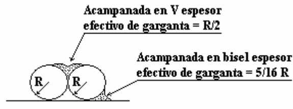
Figura 22. Detalle y nomenclatura de soldadura tope.
