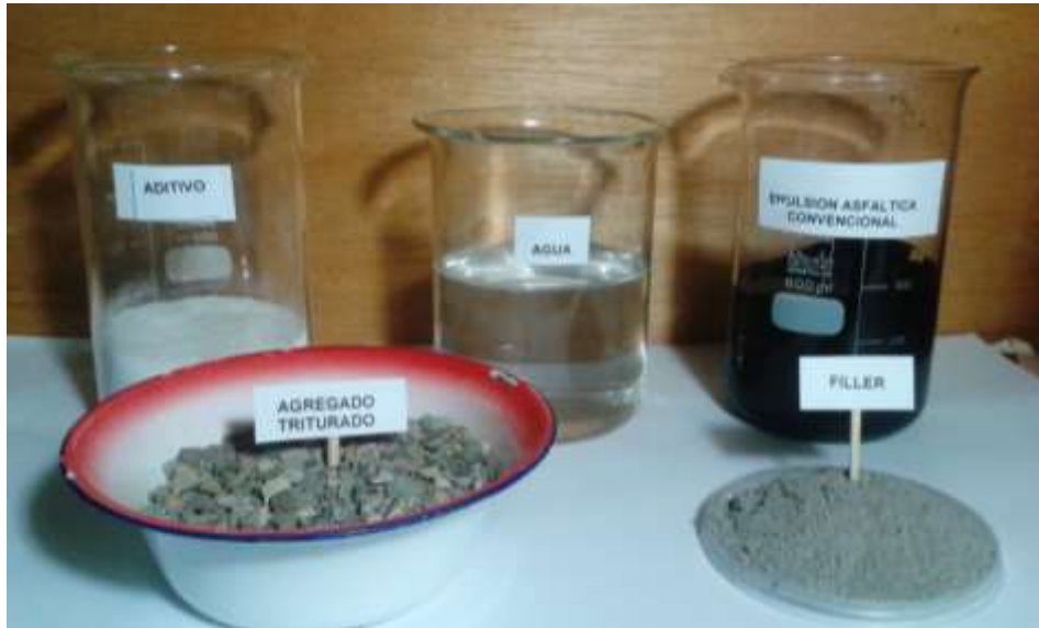
Figura 2.11: Componentes del Micro Aglomerado Asfáltico en Frio.
