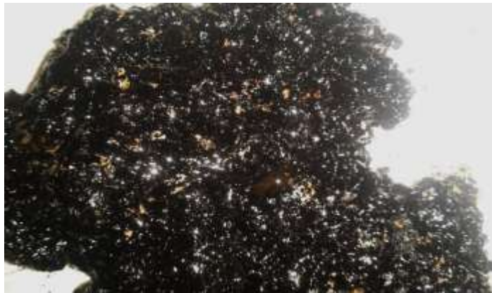
Figura 2.42: Ensayo de Cubrimiento del Agregado y la Emulsión.
