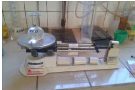
Figura 3.67. Peso del picnómetro + agua. a 25°C
