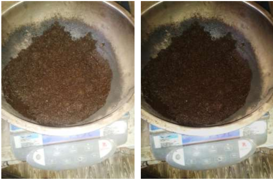
Figura 3.85: (A) Pérdida de Humedad y (B) Pesado de la Mezcla con la Humedad Óptima.
