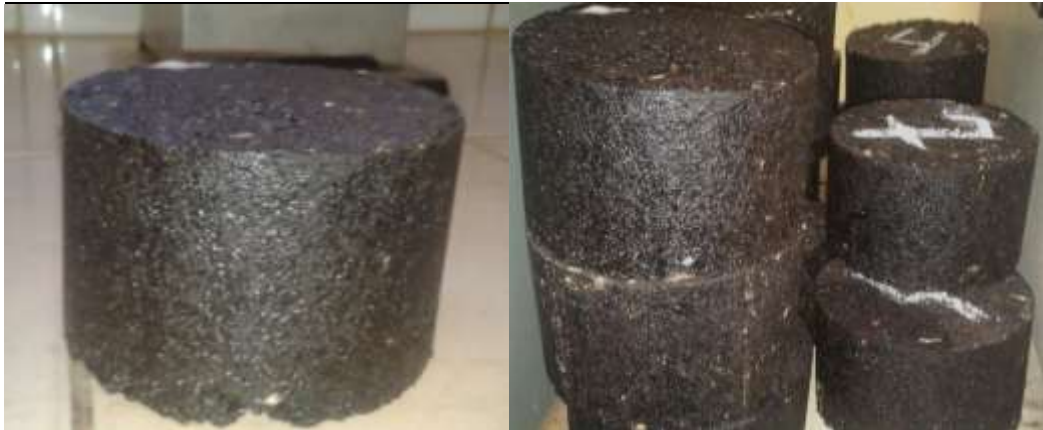
Figura 3.92: Curado de las Briquetas a Temperatura Ambiente por 14 Días.
