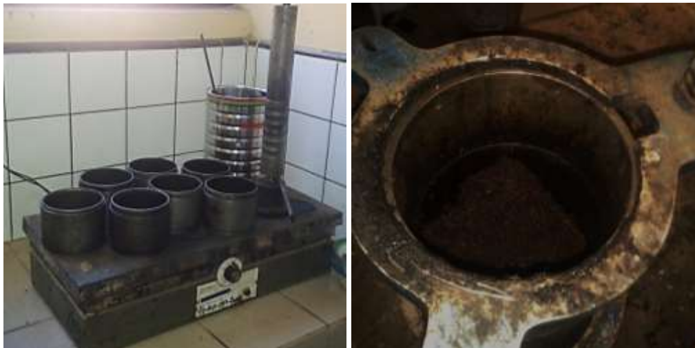
Figura 3.86: Mezcla en el Molde Marshall.
