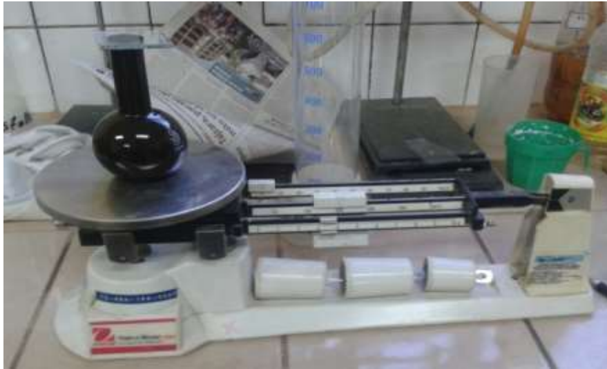
Figura 3.70. Peso del picnómetro + emulsión asfáltica
