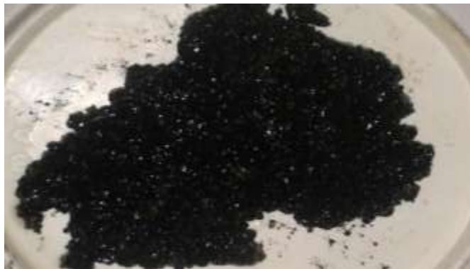
Figura 2.43: Ensayo de Adhesión de la Emulsión Sobre el Agregado.
