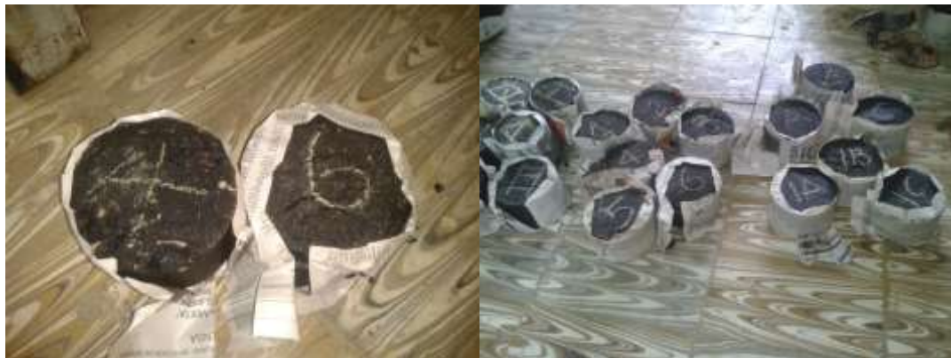
Figura 3.97: Briquetas Después del Ensayo en la Prensa Marshall.
