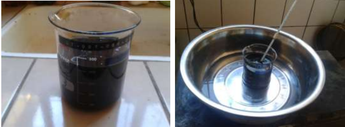
Figura 3.68. Muestra de Emulsión Asfáltica Figura 3.69 Baño María de la emulsión a 25°C.
