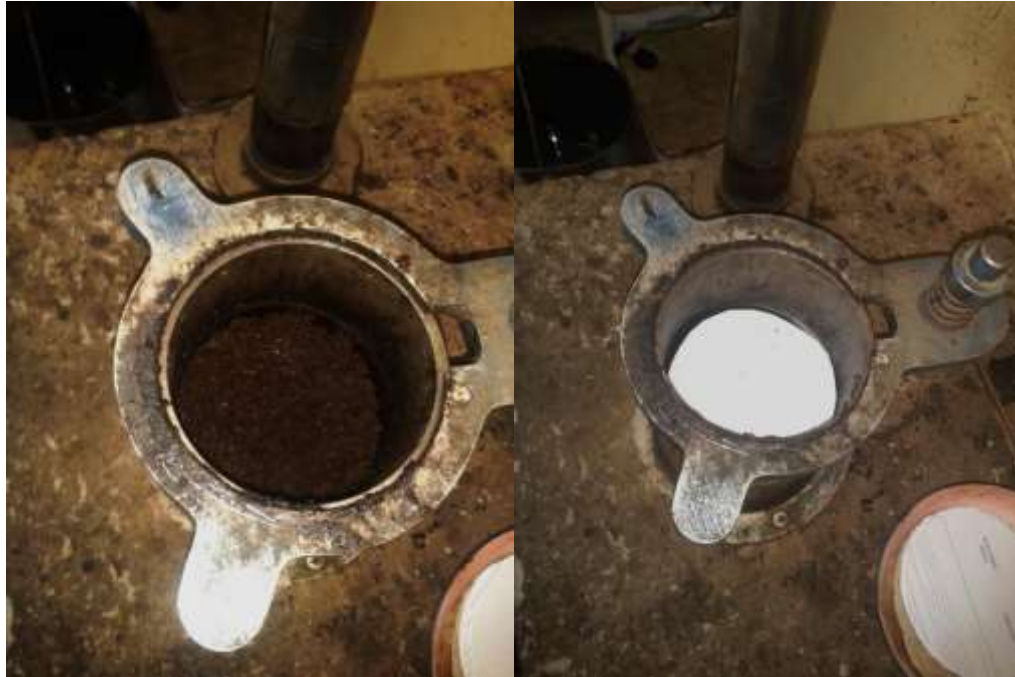
Figura 3.87: Papel Para Evitar la Adhesión del Martillo con la Briqueta
