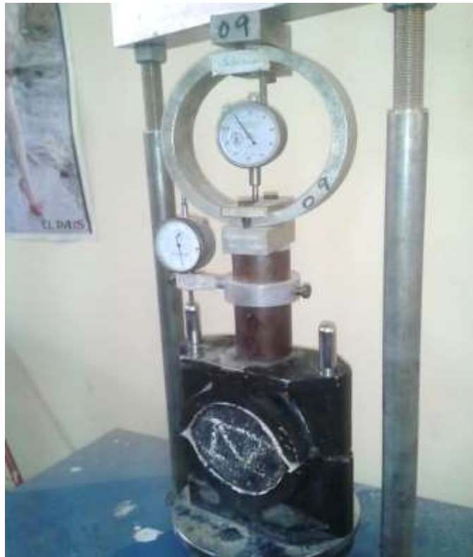
Figura 2.50: Probeta Sometida a Esfuerzos para Determinar su Estabilidad.
