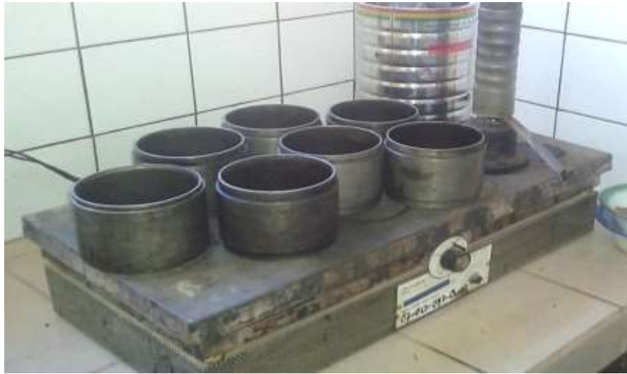
Figura 2.44: Moldes, Collarín y Base de las Briquetas Marshall.
