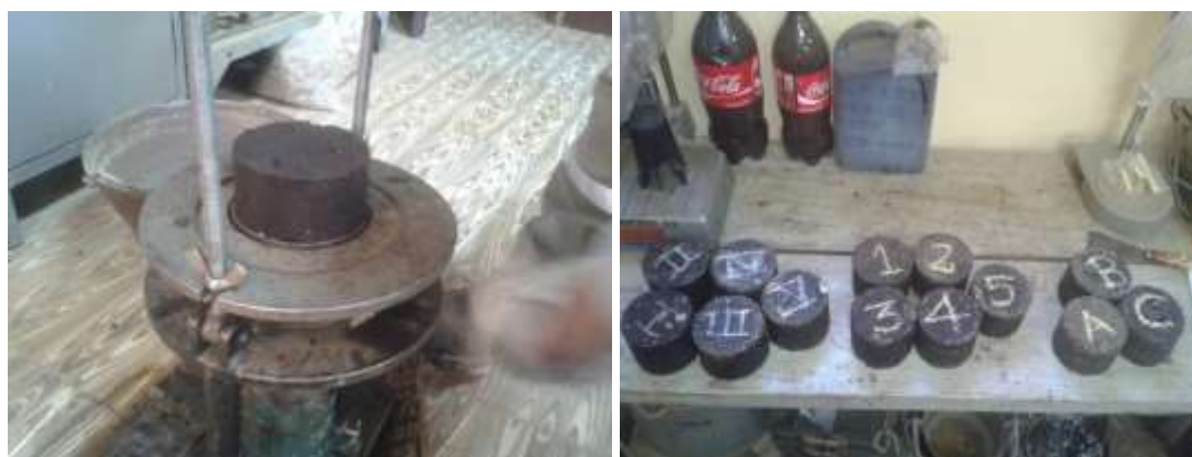
Figura 3.90: Briquetas Extraídas con Gato Hidráulico.
