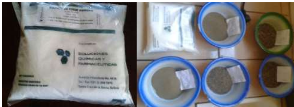
Figura 2.36: Sulfato de Sodio y el Agregado Clasificado por Tamaño.
