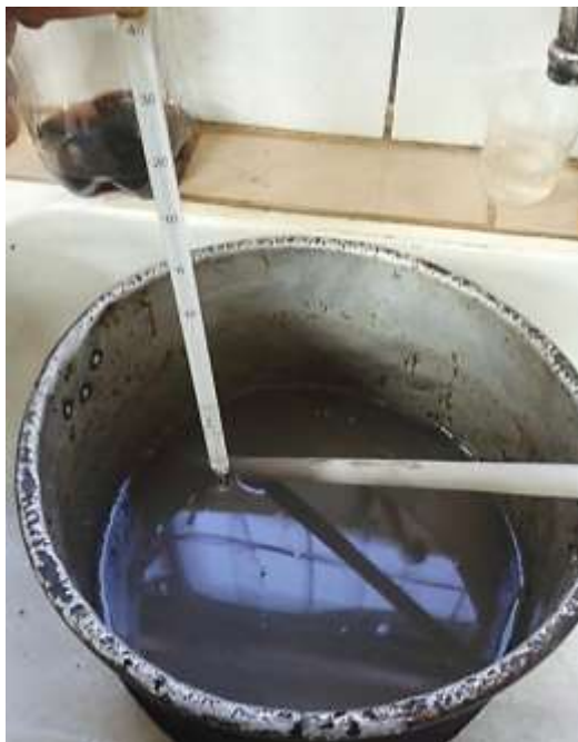
Figura 3.45. Solución de Sulfato de Sodio Figura 3.46. Muestra con la Solución
