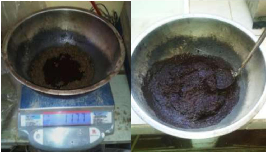
Figura 3.83: Agregado Húmedo Superficialmente Seco con Emulsión y Mezclado de Materiales.
