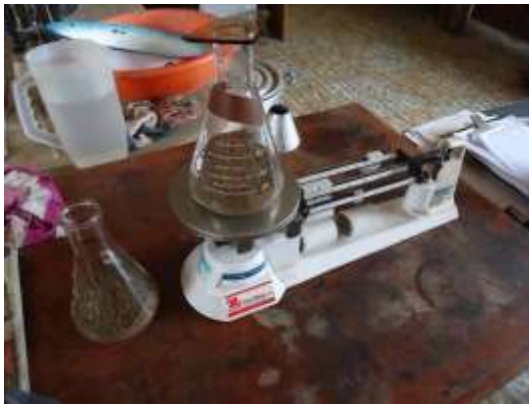
Figura 3.37. Picnómetro + Agua + Muestra
