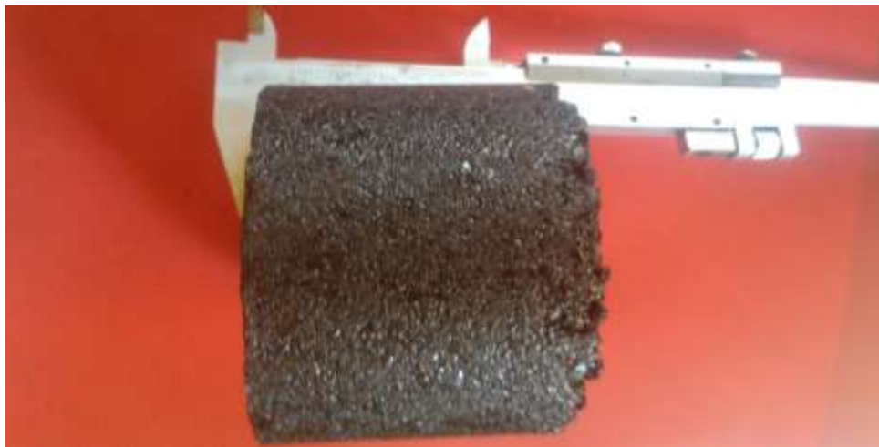
Figura 2.49: Determinación de las Alturas de las Briquetas para la Corrección.
