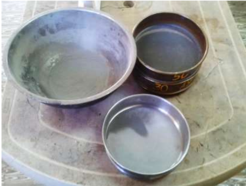
Figura 2.41: Tamizado del Cemento Portland.
