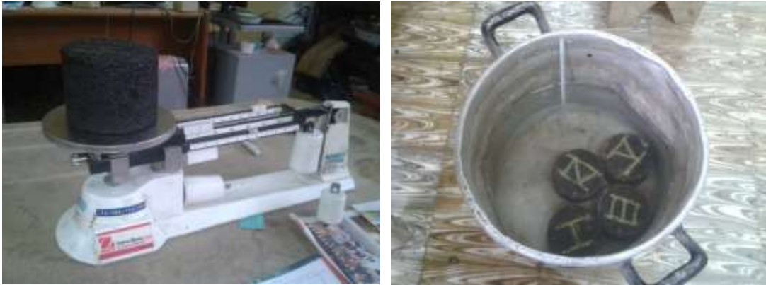
Figura 3.93: Peso Seco de Cada Briqueta y Saturado de Briquetas.
