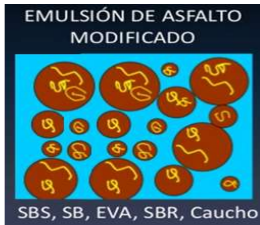
Figura 2.14: Microestructura de la Emulsión Asfáltica Modificada.
