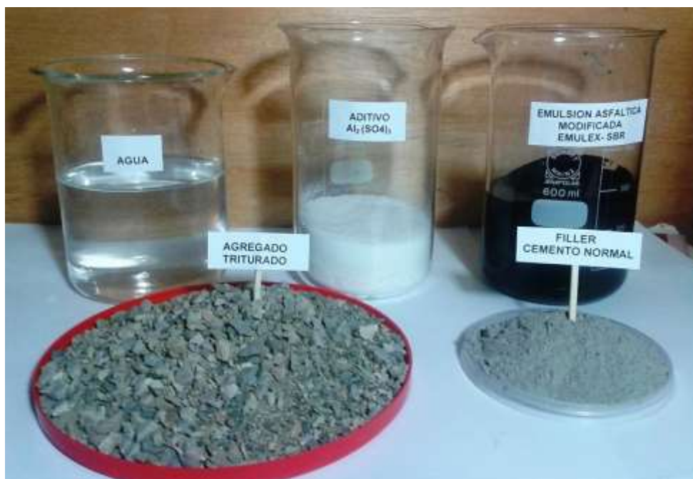
Figura 3.75. Componentes de las micro superficies.
