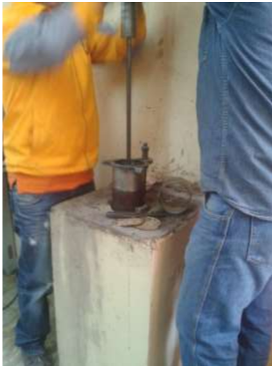
Figura 3.88: Compactado de la Briqueta con el Martillo.
