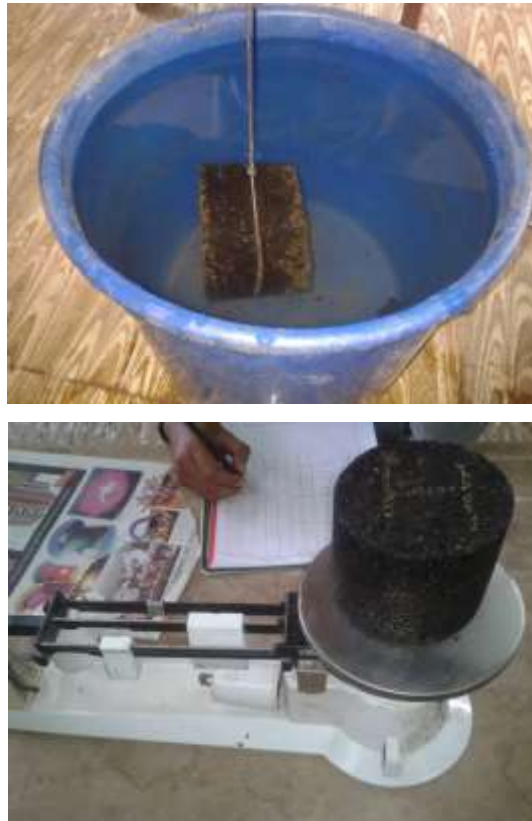
Figura 3.94: Peso en el Agua de Briqueta y Peso Saturado Superficialmente Seco.
