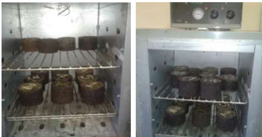
Figura 3.91: Curado de las Briquetas en el Horno.
