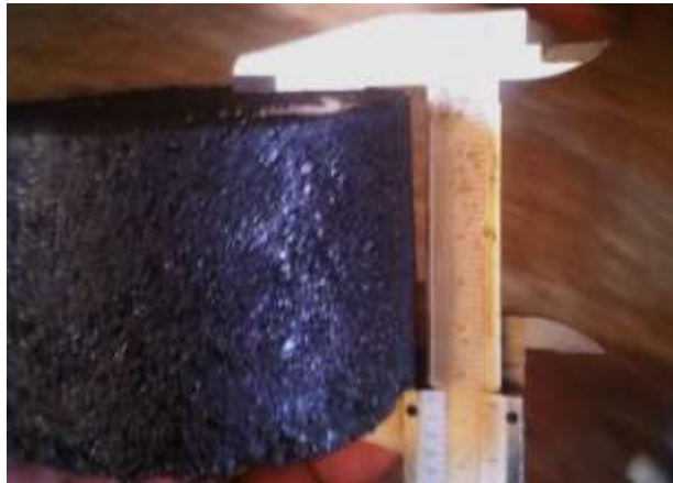
Figura 3.98: Lecturas de Dimensiones de las Briquetas Para su Corrección por su Altura.
