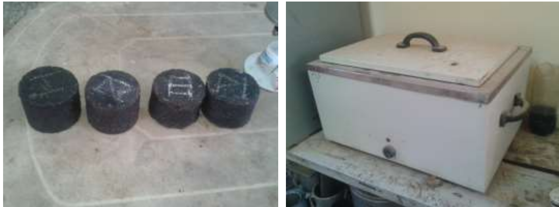
Figura 3.95: Briquetas para Sumergir en el Baño María.
