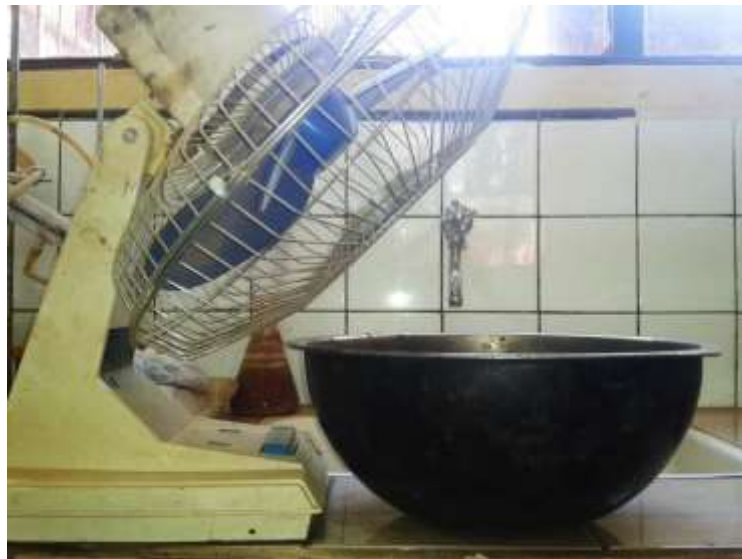
Figura 3.84: Incrementando la Perdida de % Humedad de la Mezcla con el Ventilador
