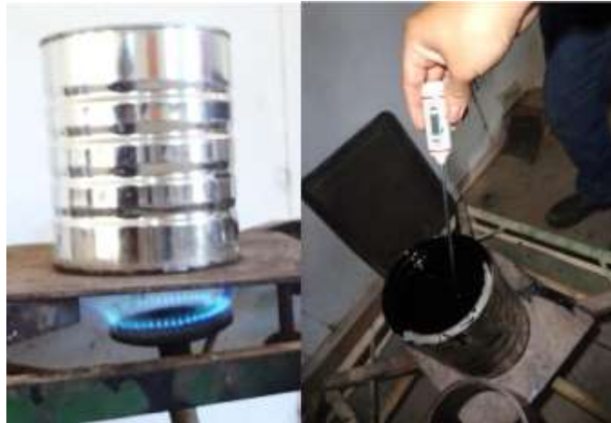
Fig. 3.31 Calentamiento del asfalto para poder elaborar la mezcla.
