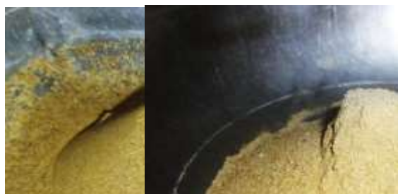
Fig. 3.14 Revisión de humedad post ensayo peso específico árido fino
