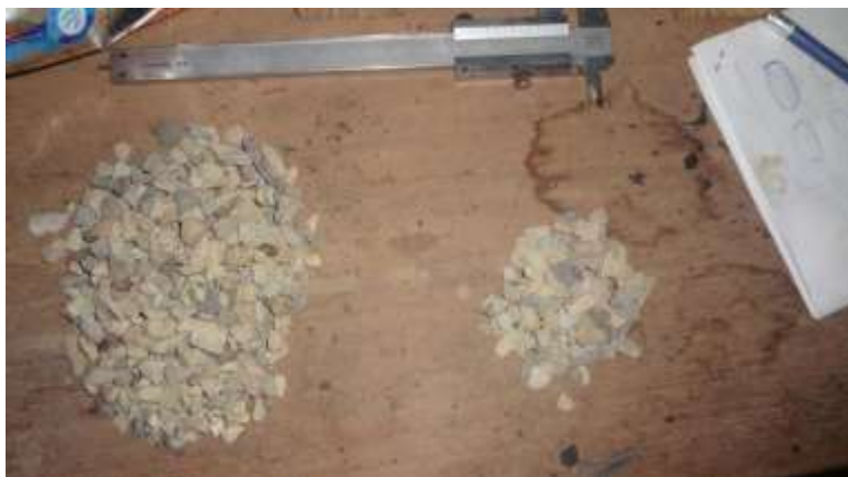
Fig. 3.17 Partículas laminadas y caras fracturadas
