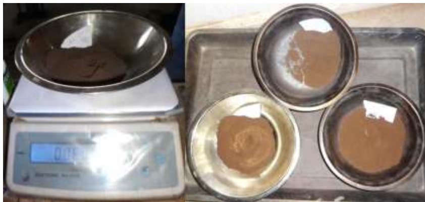
Fig. 3.42 Pesaje e identificación de aditivo
