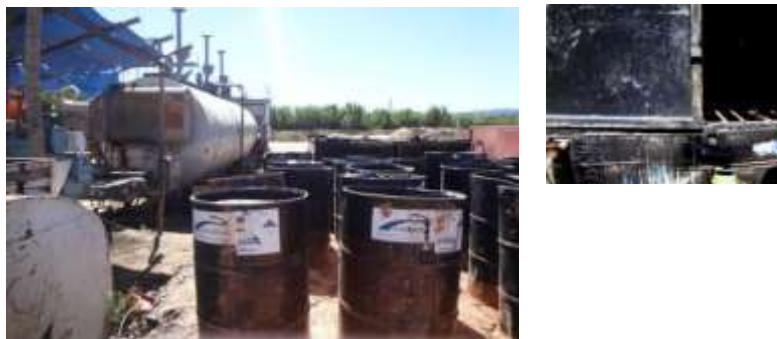
Fig. 3.4 Turriles de la planta asfaltadora y toma de la muestra cemento asfáltico
