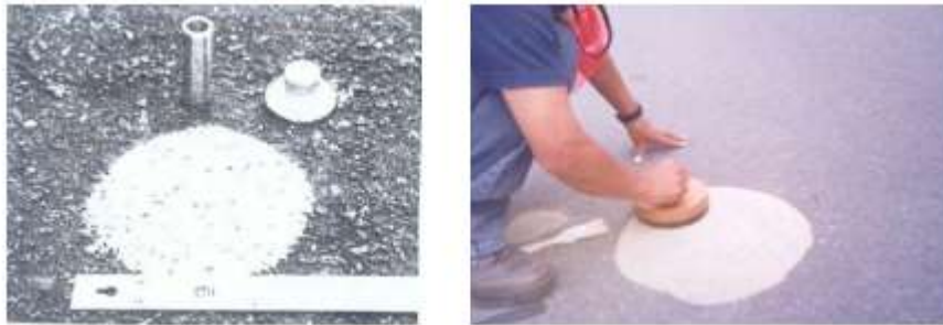
Figura N° 16 Ensayo de la mancha de arena
