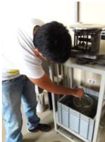
Figura N° 31 Pesado del agregado grueso sumergido.
