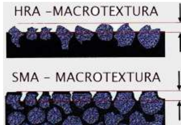
Figura N° 15 Macrotextura en pavimentos antiguos y nuevos
