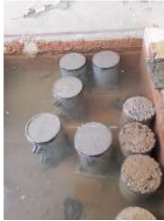
Figura N° 38 Curado de probetas en laboratorio.
