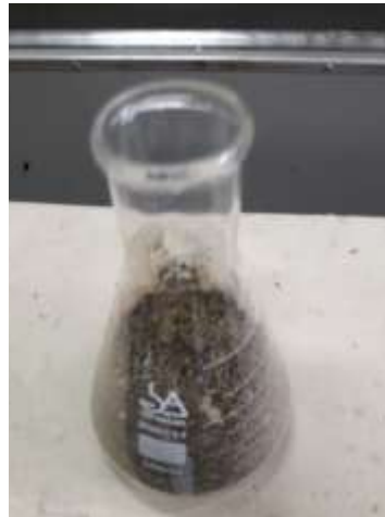
Figura N° 33 Arena superficialmente seca en matraz 500ml.
