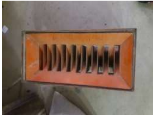
Figura N° 19 Cuarteador "laboratorio de suelos U.A.J.M.S.
