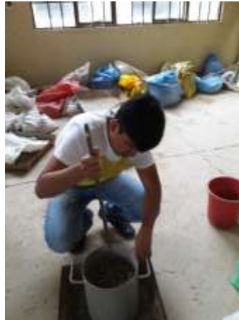
Figura N° 29 Varillado del agregado grueso.
