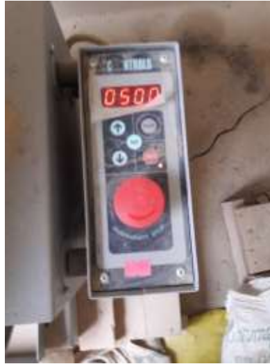
Figura N° 36 Revoluciones programadas máquina de desgaste de Los Ángeles.
