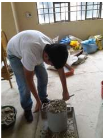
Figura N° 28 Enrase de molde volumétrico sin varillar.
