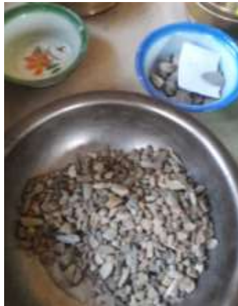
Figura N° 35 Muestra de agregado grueso ensayo de alargamiento y aplanamiento.
