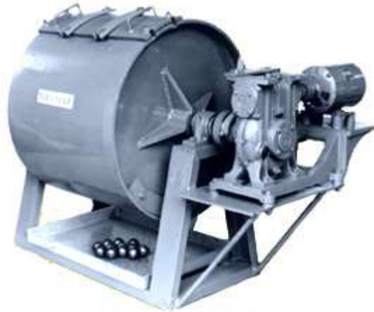
Figura N° 6 Maquina de Los Ángeles (resistencia agregados)
