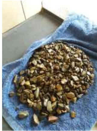
Figura N° 30 Secado superficial agregado grueso.
