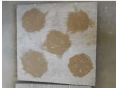
Figura N° 68 Ensayo de la mancha de arena a diferentes nudos de la losa.
