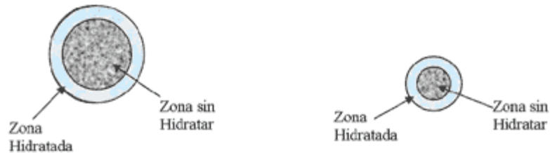
Figura N° 5 Pérdida de la finura causada por la hidratación.
