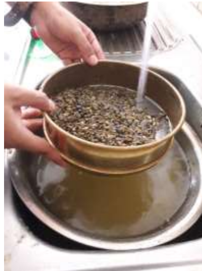
Figura N° 26 Lavado del agregado fino.
