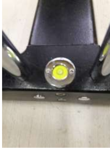
Figura N° 51 Nivelación del péndulo británico.
