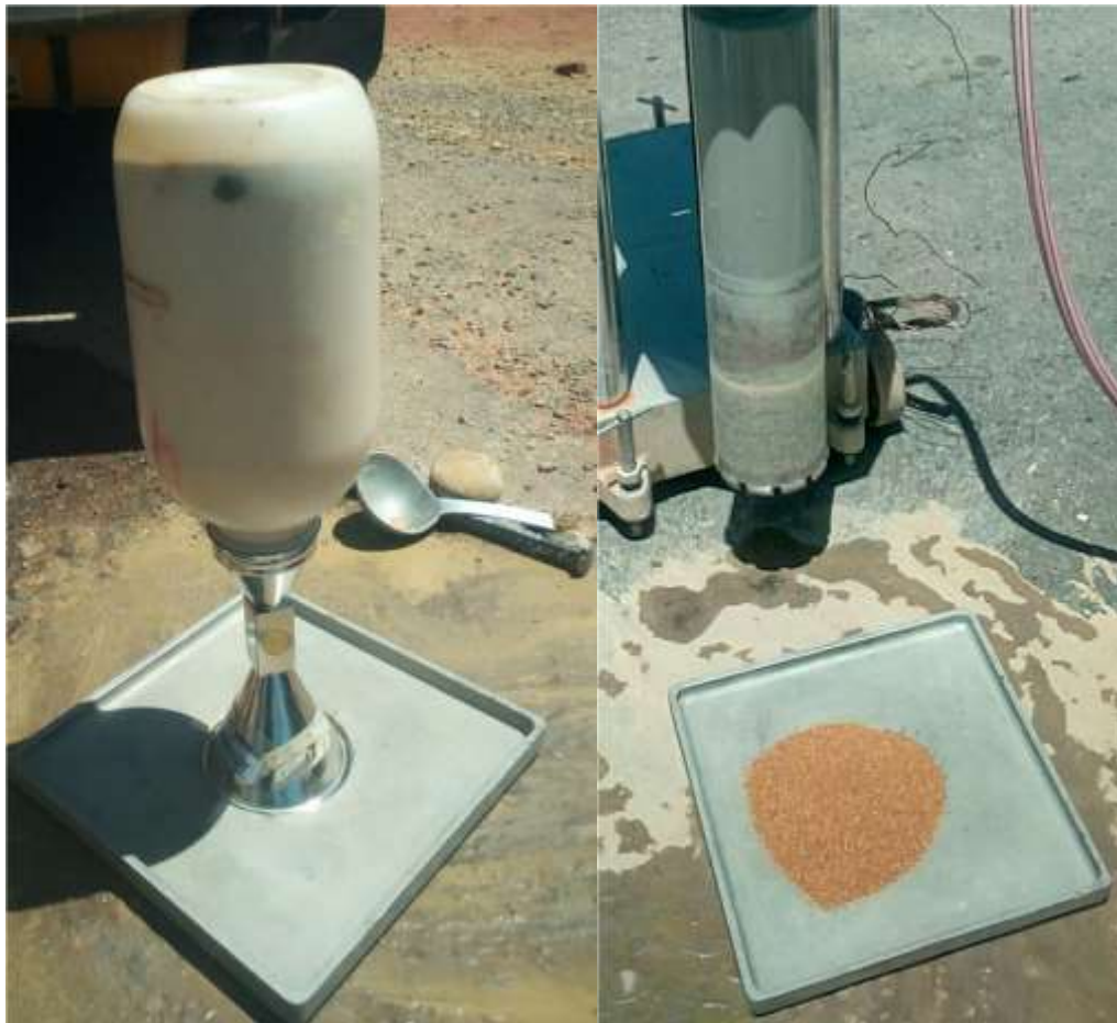
FIGURA N° 2.20. Ensayo de densidad in situ
