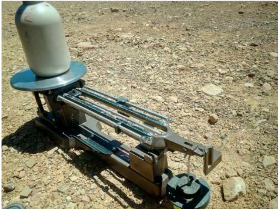
FIGURA N° 2.21. Ensayo densidad in situ, peso del aparato más cono con la arena que quedo después de vaciar al hoyo.
