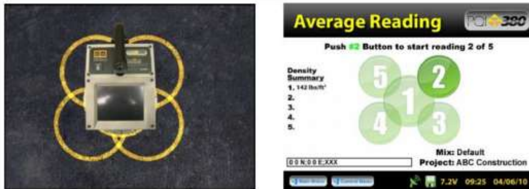
FIGURA N° 2.14. Toma de lectura promedio de para la calibración
