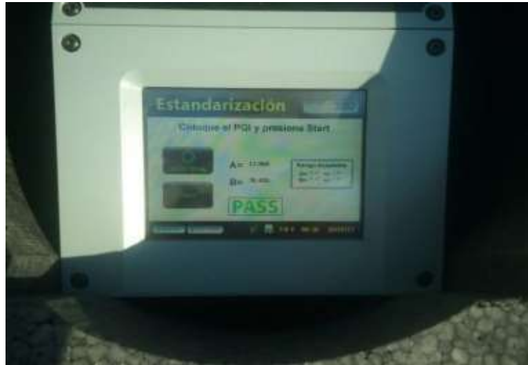
FIGURA N° 2.18. Calibración mediante la placa de verificación
