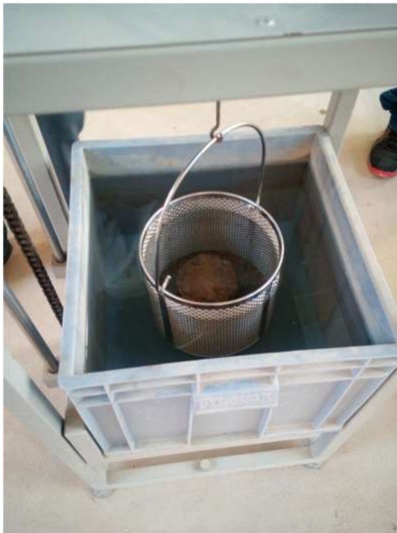
FIGURA N° 2.25. Peso de las briquetas sumergidas
