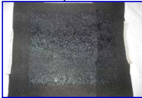
Figura 3.74. Geotextil después de la absorción del ligante
