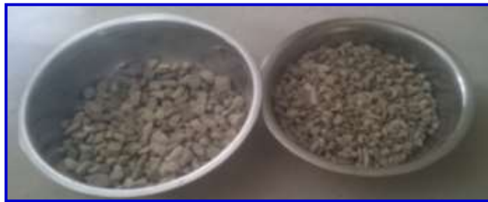
Figura 3.20. Material seleccionado para el ensayo de desgaste de los ángeles
