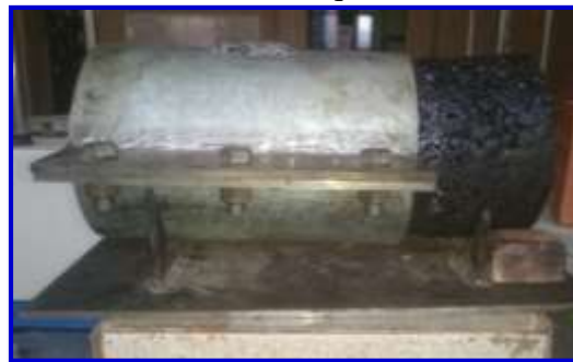
Figura 3.66. Colocado de la briqueta dentro de la mordaza
