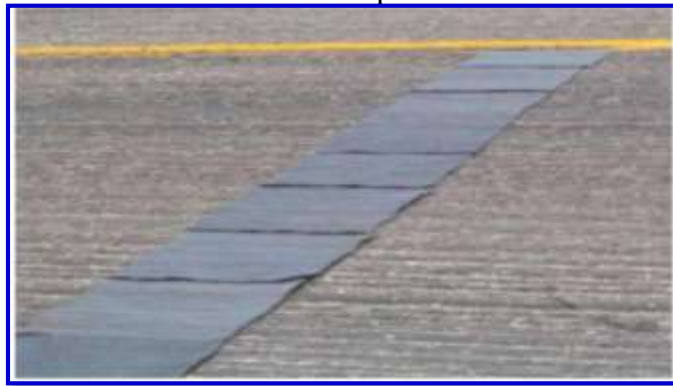
Figura 2.20. Colocado del material para la medición de la dotación
