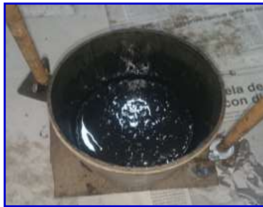
Figura 3.53. Colocado de la briqueta con riego dentro del molde después de un tiempo de reposo especificado
