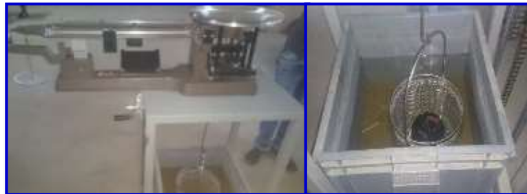
Figura 3.42. Determinación del peso sumergido
