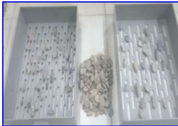
Figura 3.23. Determinación del porcentaje de lajas
