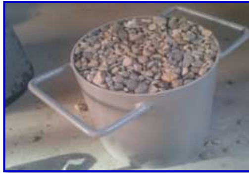
Figura 3.16. Peso unitario del agregado grueso (gravilla)
