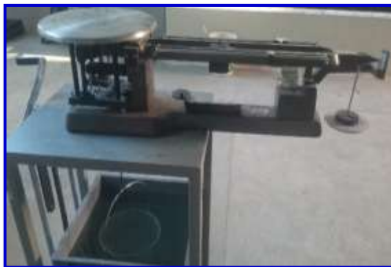
Figura 3.11. Obtención del peso sumergido de la muestra
