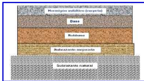
Figura 2.3. Sección típica de un pavimento flexible
