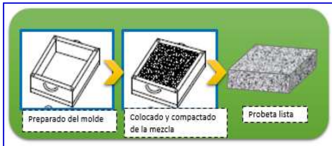
Figura 3.60. Esquema de construcción de las probetas prismáticas
