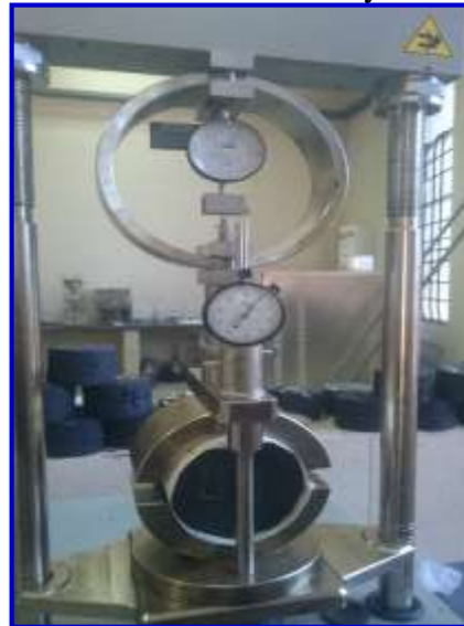
Figura 3.45. Determinación de la estabilidad y fluencia de las briquetas
