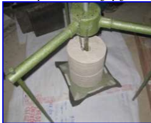
Figura 3.71. Dispositivo con carga y geotextil en reposo
