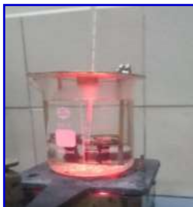
Figura 3.31. Realización del ensayo de punto de ablandamiento
