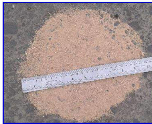
Figura 3.62. Medición de la textura superficial
