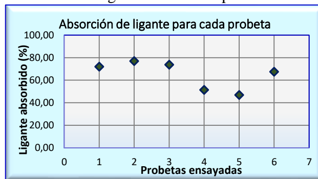
Figura 3.80. Absorción de geotextil PP-300 para una dotación de 0,4 lt/m 2
