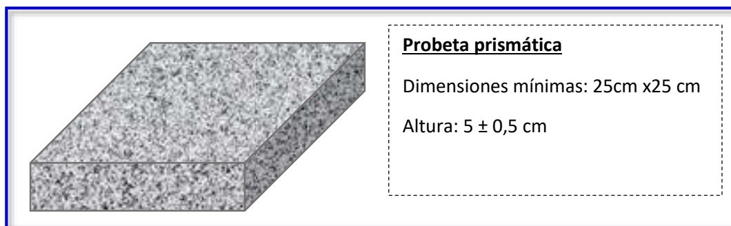
Figura 3.56. Estructura de la probeta prismática
