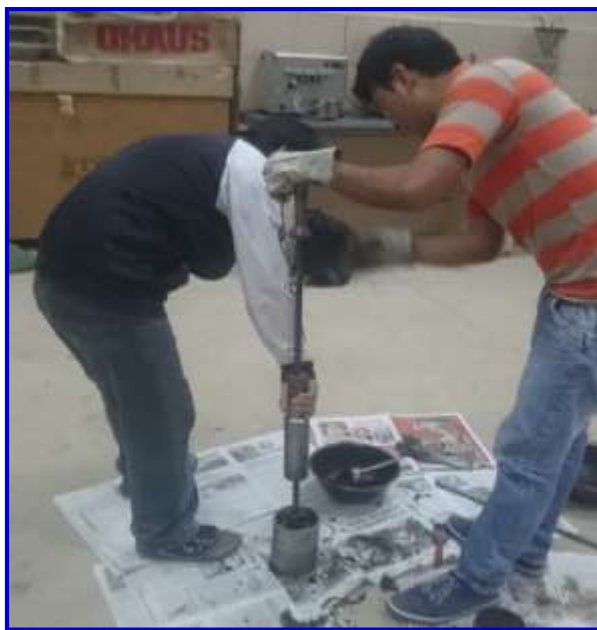
Figura 3.38. Compactación de la muestra, dando 75 golpes por cara
