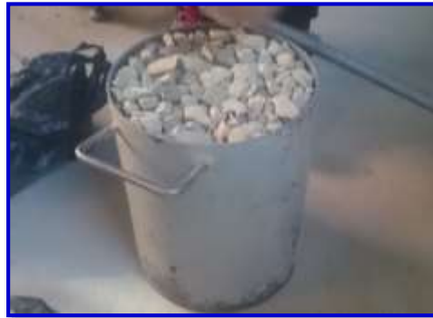
Figura 3.15. Peso unitario del agregado grueso (grava)
