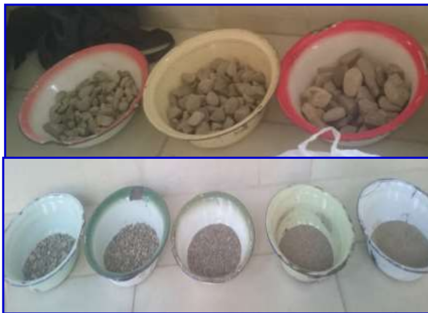
Figura 3.24. Fracción de material retenido en los diferentes tamices
