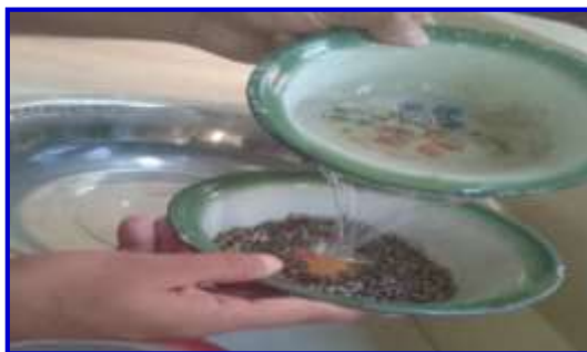
Figura 3.26. Inmersión de la muestra en el sulfato de sodio
