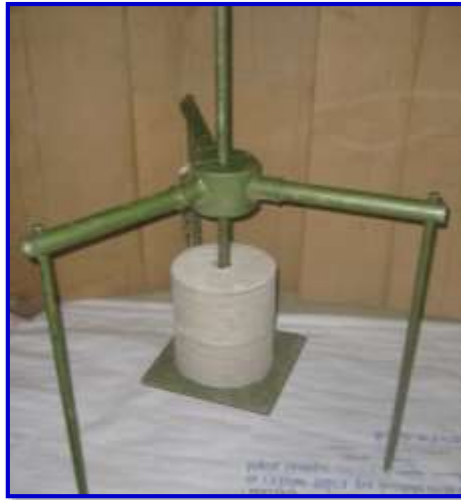
Figura 3.70. Dispositivo de medición de riego de liga
