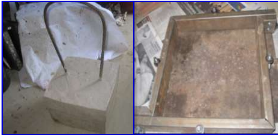
Figura 4.58. Compactador manual casero y molde para la construcción de probetas
