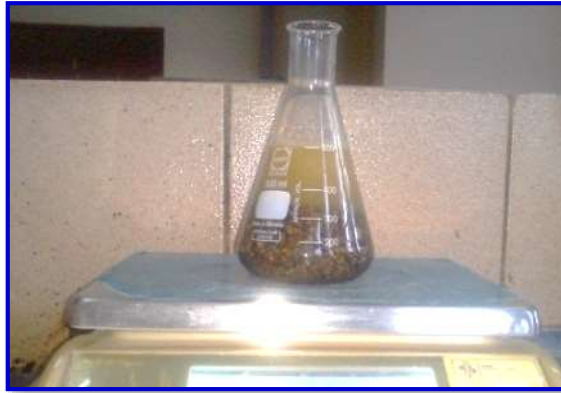
Figura 3.14. Determinación del peso sumergido
