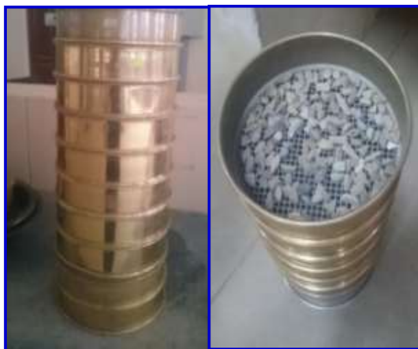
Figura 3.5. Tamizado mediante los tamices normalizados ASTM
