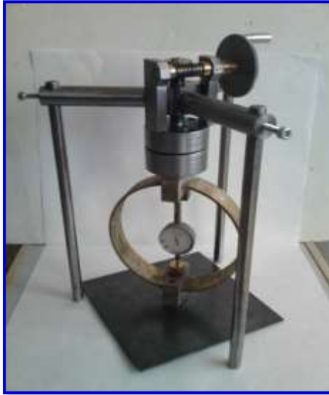
Figura 2.34. Instrumento para el control de la dotación con anillo dinamométrico
