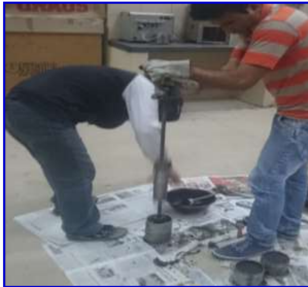
Figura 3.51. Compactado de la muestra con 150 golpes
