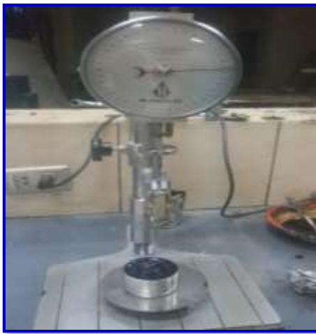
Figura 3.27. Realización de la penetración de la muestra
