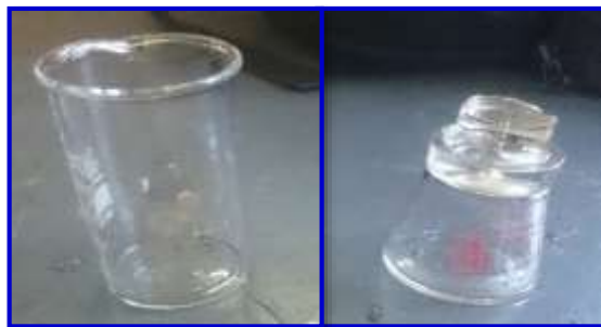
Figura 3.32. Picnómetros utilizados para determinar el peso específico
