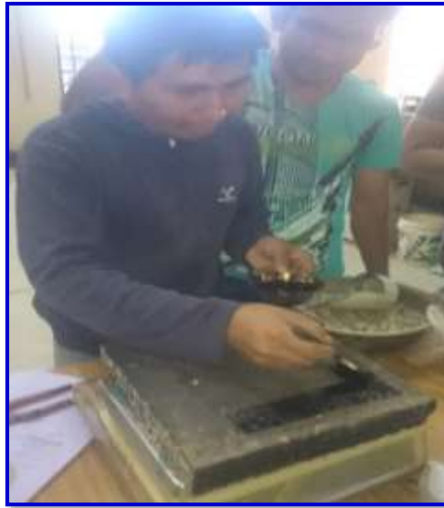
Figura 3.72. Extensión del riego de adherencia
