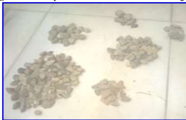
Figura 3.22. Separación de caras fracturas del agregado
