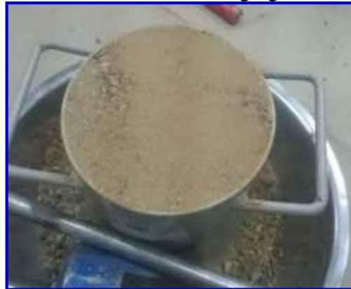
Figura 3.17. Peso unitario del agregado fino (arena)
