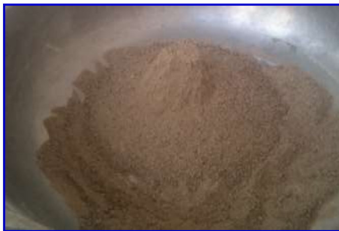
Figura 3.13. Verificación de la condición de saturado con superficie seca
