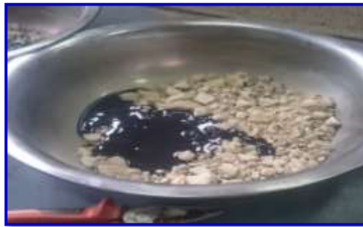
Figura 3.49. Preparado de la muestra previo al mezclado
