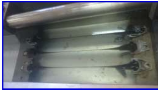
Figura 3.28. Ensayo de ductilidad
