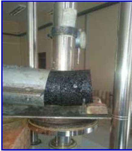
Figura 3.67. Realización del ensayo de corte LCB
