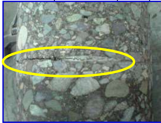
Figura 2.33. Falla en una probeta doble capa en el plano de unión
