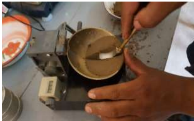
Figura N°25: Realizando la ranura en el aparato casa grande
