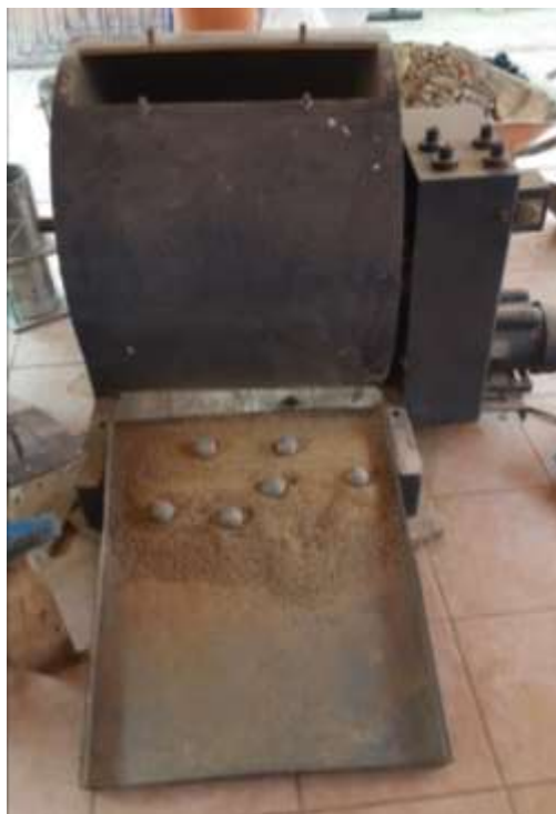
Figura N°24: Agregado fino después de pasar por el aparato desgaste de los ángeles
