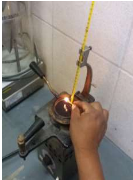
Figura N°29: Punto de inflamación en proceso de ejecución
