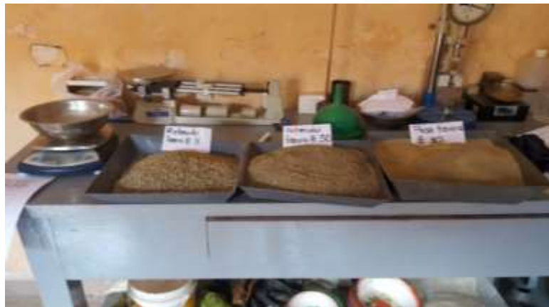
Figura N°35: Arena tamizada para la dosificación
