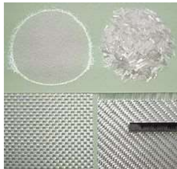
Figura 3.12: FIBRAS DE VIDRIO EMPLEADAS COMO REFUERZO EN EL PRFV
