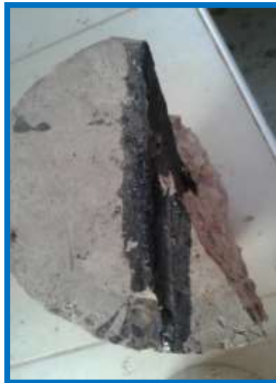
Figura 3.124: Muestra de pavimento rígido sellada con alquitrán con rotura a compresión
