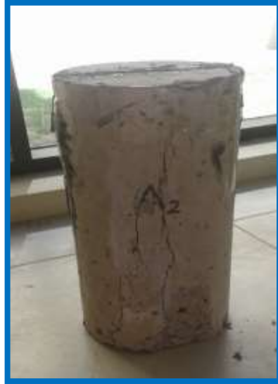
Figura 3.130: Muestra de pavimento rígido sellada con mástic asfáltico con rotura a compresión
