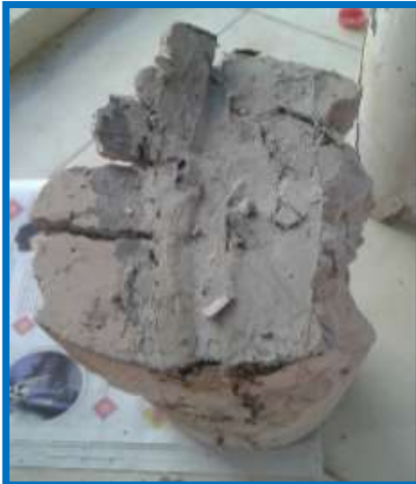
Figura 3.134: Muestra de pavimento rígido sellada con Sikaflex PRO-3 con rotura a compresión
