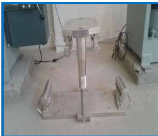
Figura 3.109: Equipo de flexión para ensayo a muestra de pavimento rígido
