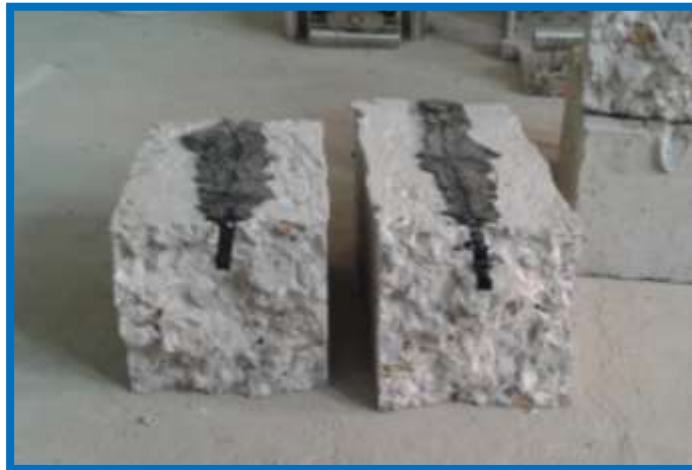
Figura 3.125: Muestra de pavimento rígido sellada con alquitrán con rotura a flexión
