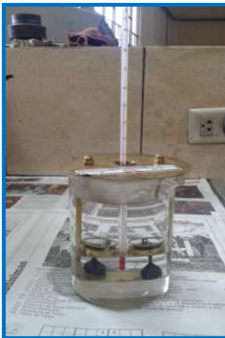
Figura 3.35: Ensayo de punto de ablandamiento
