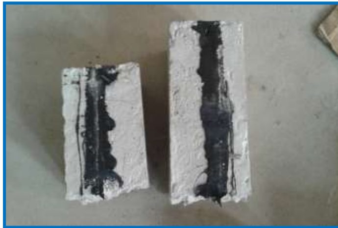
Figura 3.133: Muestras de hormigón selladas con alquitrán con rotura a flexión
