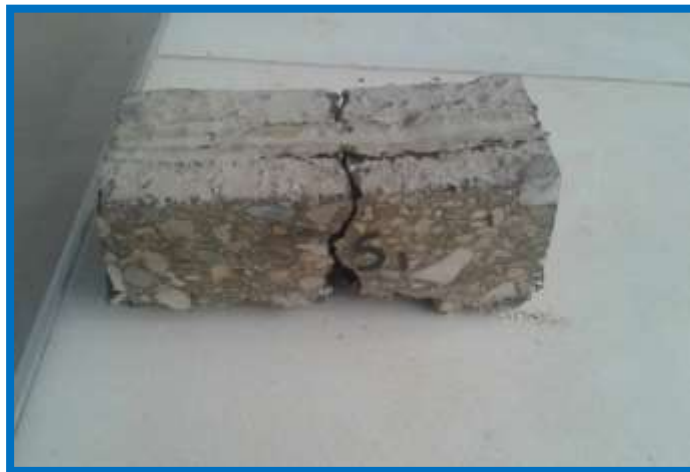
Figura 3.119: Muestra de pavimento flexible sellada con Sikaflex PRO-3 con rotura a flexión
