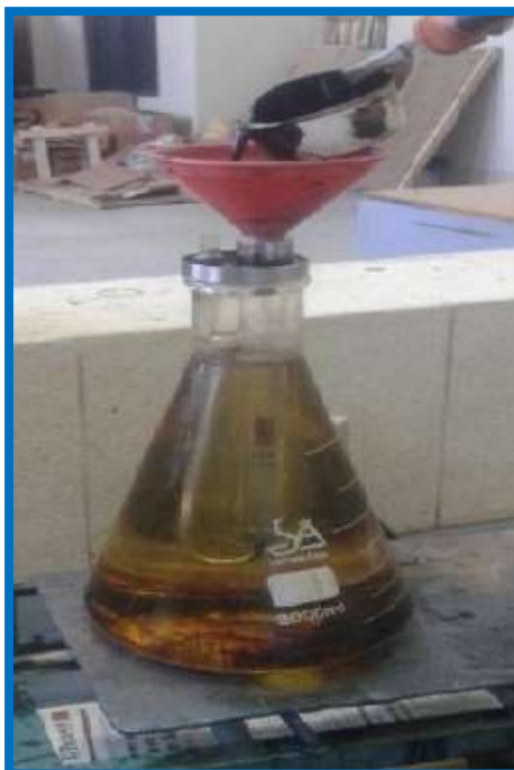
Figura 3.37: Ensayo de viscosidad cinemática
