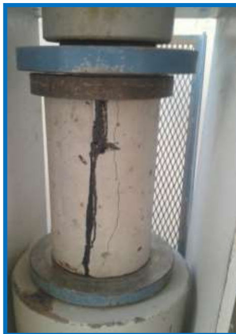
FIGURA 3.111: Compresión a muestra sellada de pavimento rígido
