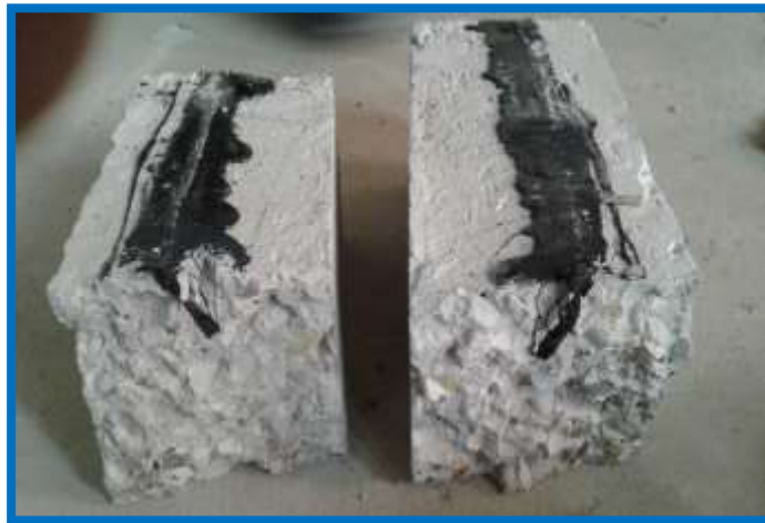
Figura 3.123: Muestra de pavimento rígido sellada con mástic asfáltico con rotura a flexión
