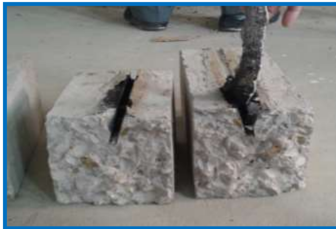
Figura 3.127: Muestra de pavimento rígido sellada con Sikaflex PRO-3 con rotura a flexión
