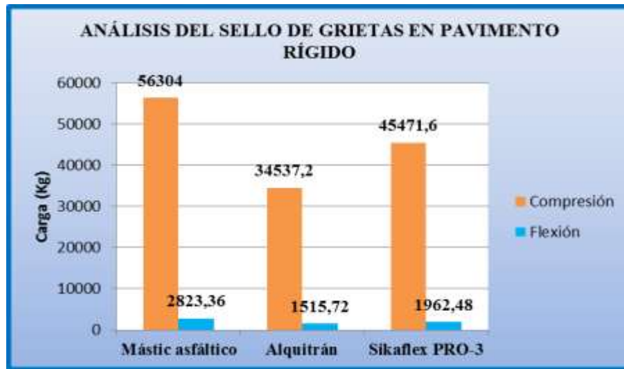
Gráfica 3.32: Análisis del sello de grietas en pavimento rígido
