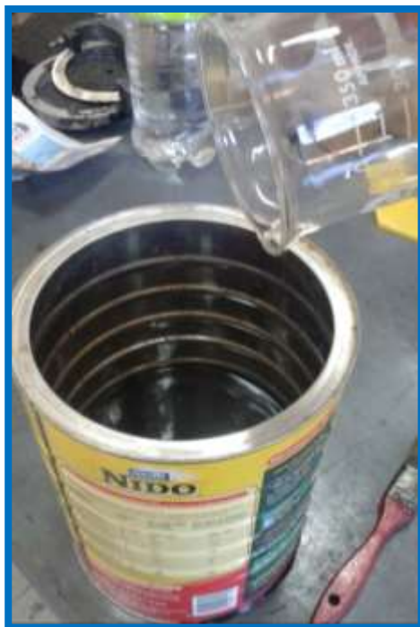
Figura 3.71: Preparación de MC-70
