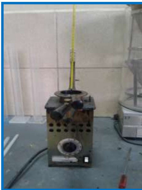
Figura 3.34: Ensayo de punto de inflamación
