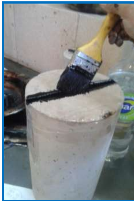
Figura 3.93: Imprimación de la superficie a sellar
