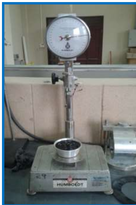
Figura 3.32: Ensayo de penetración
