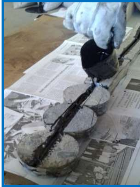
Figura 3.79: Aplicación de los sellos a muestras de pavimento
