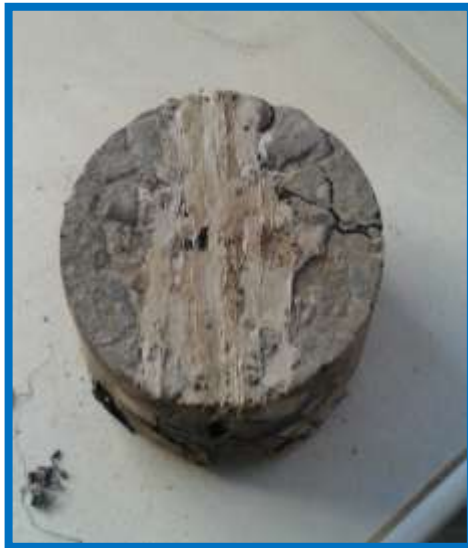
Figura 3.118: Muestra de pavimento flexible sellada con Sikaflex PRO-3 con rotura a compresión
