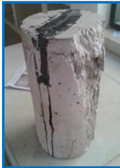
Figura 3.122: Muestra de pavimento rígido sellada con mástic asfáltico con rotura a compresión
