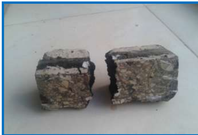
Figura 3.115: Muestra de pavimento flexible sellada con mástic asfáltico con rotura a flexión
