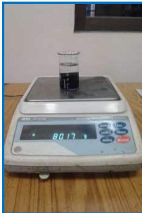
Figura 3.36: Ensayo de peso específico
