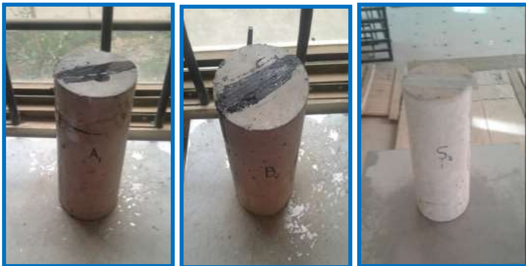
Figura 3.96: Grietas y juntas selladas en las muestras de pavimento rígido
