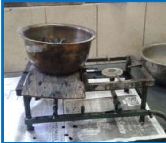
Figura 3.77: Calentado del alquitrán
