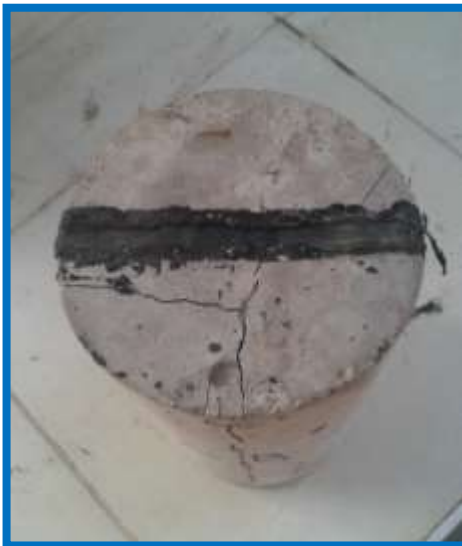
Figura 3.132: Muestra de pavimento rígido sellada con alquitrán con rotura a compresión
