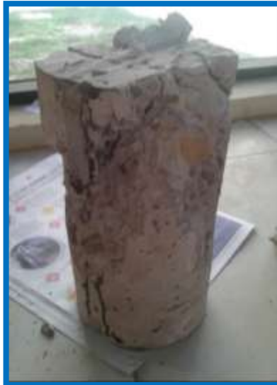
Figura 3.126: Muestra de pavimento rígido sellada con Sikaflex PRO-3 con rotura a compresión
