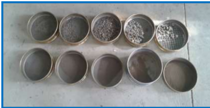
Figura 3.30: Muestra retenida en cada tamiz
