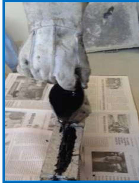
Figura 3.79: Aplicación de los sellos a muestras de pavimento
