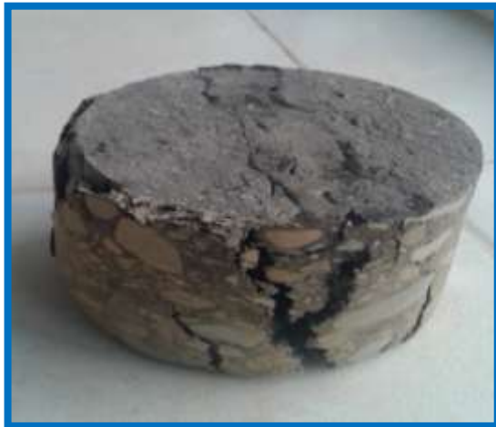
Figura 3.116: Muestra de pavimento flexible sellada con alquitrán con rotura a compresión
