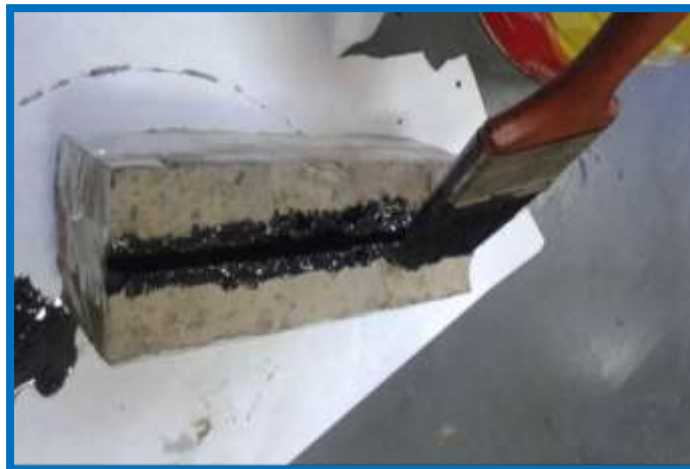
Figura 3.73: Imprimación de la muestra asfáltica
