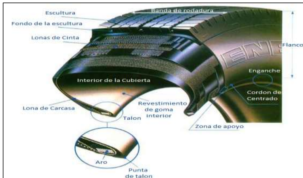
Figura 16: Principales partes de un neumático
