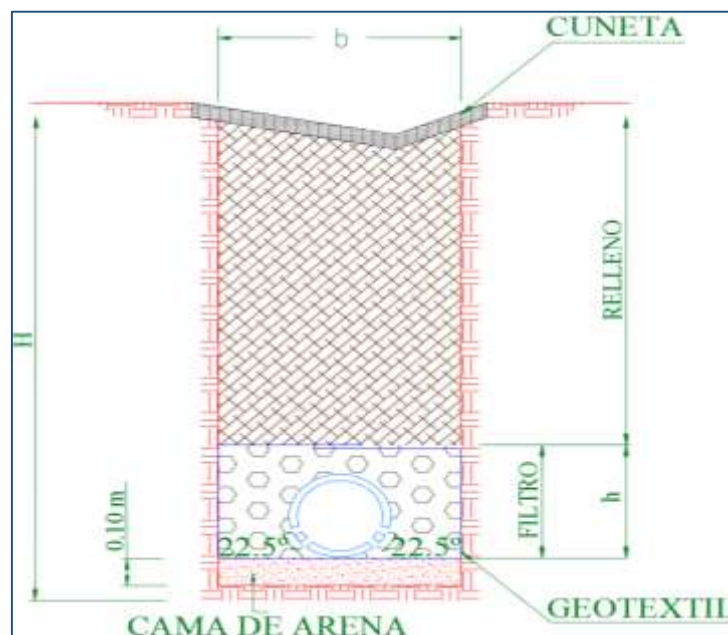
Esquema 4: Sección transversal del subdren
