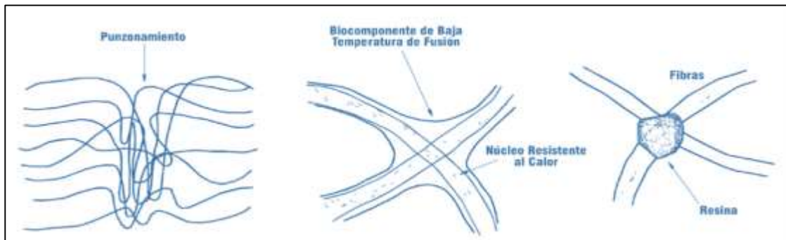
Figura 13: Diagrama esquemático de varios tipos de unión de fibras en geotextiles no tejidos
