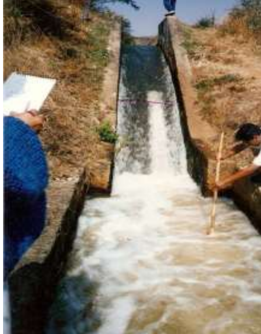
Figura 3.2. Flujo turbulento en una rápida.
