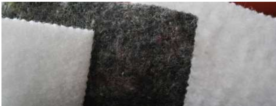
Figura 4.14. Geotextil no tejido punzonado por agujas. Fuente: Elaboración propia.
