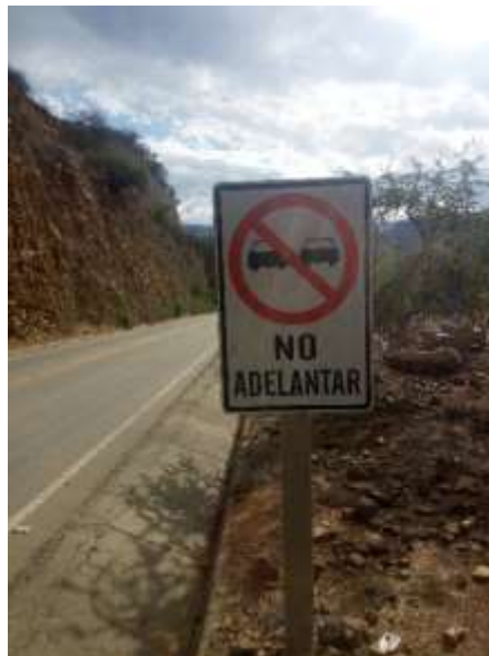
Figura N° 3.23. Señal reglamentaria no adelantar TCA 3
