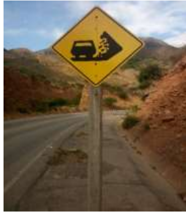
Figura N° 3.24. Señal preventiva zona de derrumbes TCA 3
