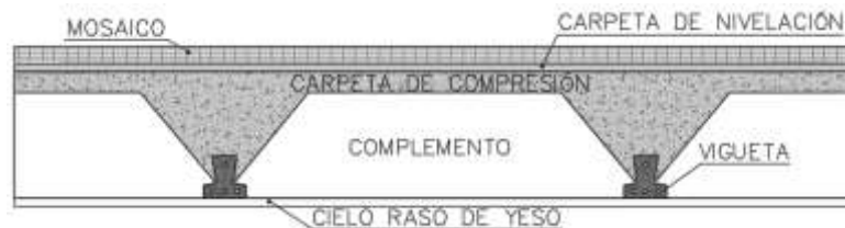
Figura 3.3 Corte transversal de losa de viguetas
