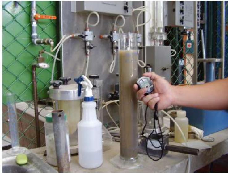
Figura 52. Separación de las fases de un suelo.
