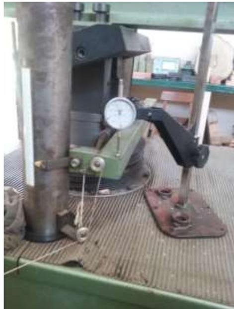
*Figura 17b: Extensómetro*
