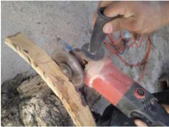
*Figura 34c: redimensionado de la pieza*
