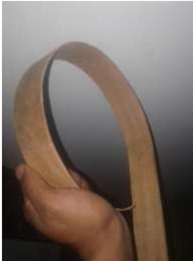
*Figura 31: Curvado de la madera después de someter a calor*
