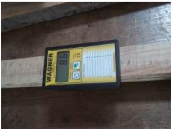
*Figura 24a: Medición del contenido de humedad antes del ensayo*
