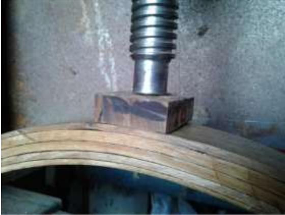
*Figura 35b: Aplicación de fuerza en la clave*
