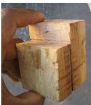
*Figura 21: Probeta para ensayo de cizalle en la línea de encolado*
