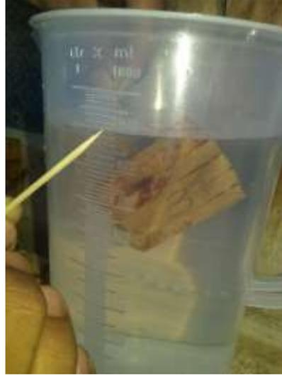
*Figura 29b: determinación del volumen por inmersión*
