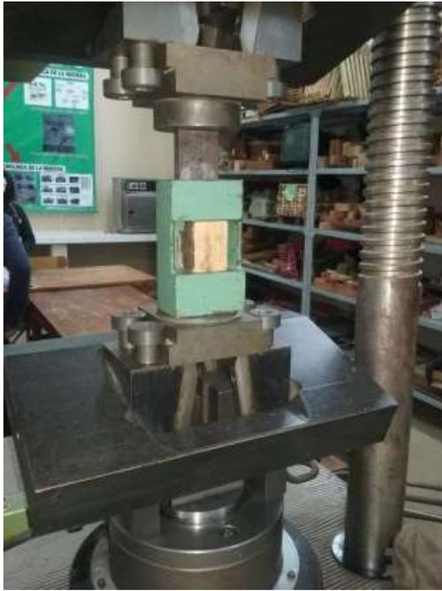
*Figura 25a: Ejecución del ensayo de cizalle en la prensa universal universal*
