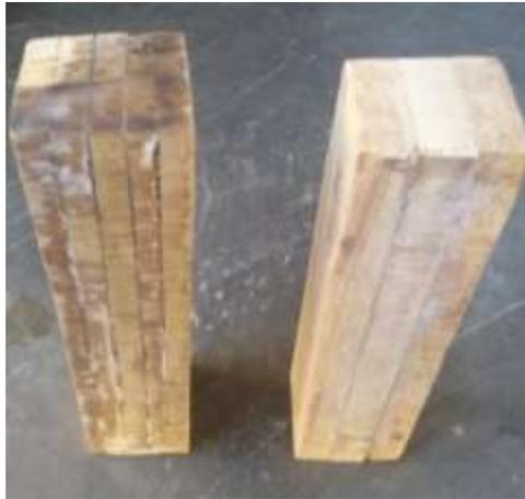
*Figura 22: Probeta para ensayo de compresión paralela*
