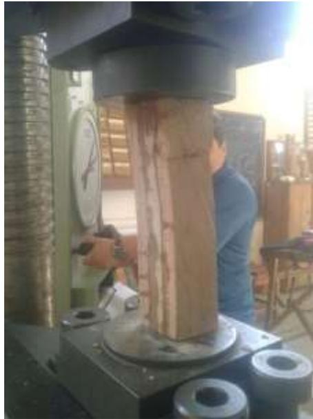
*Figura 26: ejecución del ensayo de compresión paralela*
