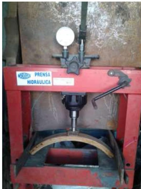
*Figura 35a: Disposición de la pieza en la prensa*
