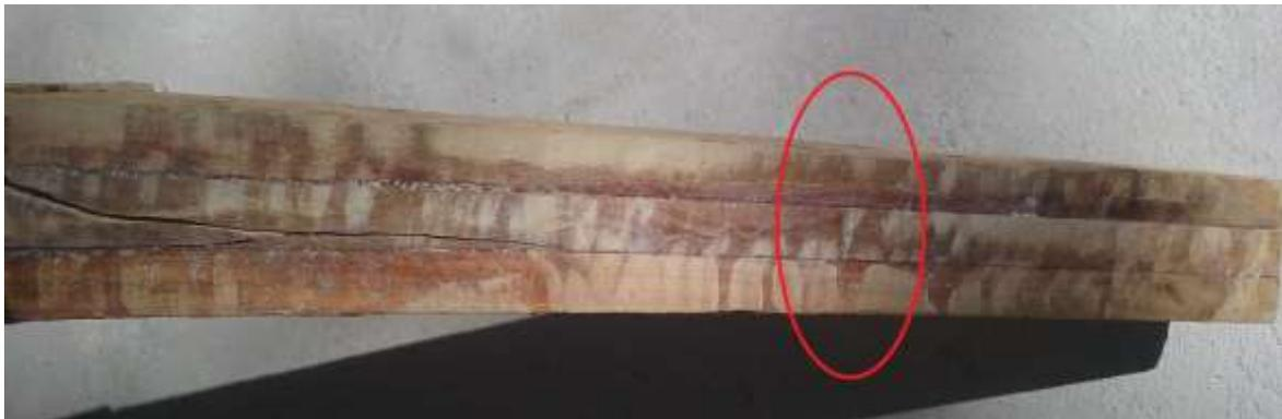
*Figura 43: Uniones finger joints ubicada en la lámina central y al extremo sin fallas después del ensayo de flexión*
