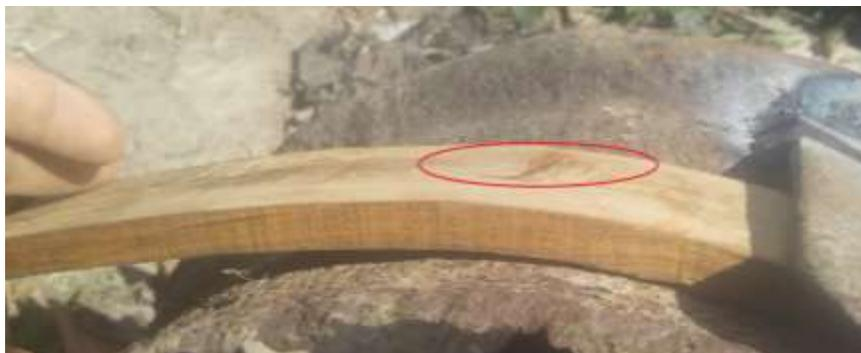
*Figura 45: Falla en la zona traccionada por forzar al curvado de láminas de espesor mucho mayor al recomendado y/o a poco tiempo de vaporización.*
