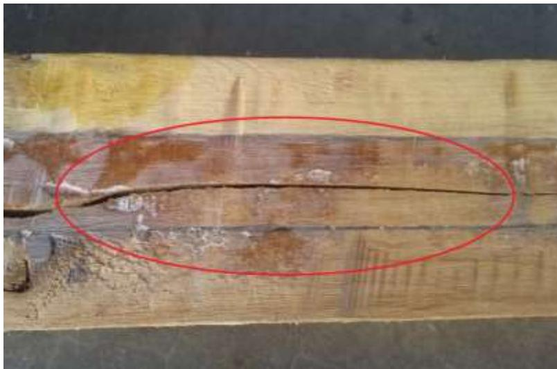
*Figura 40: Cortante horizontal en el eje neutro. Líneas de cola intactas.*
