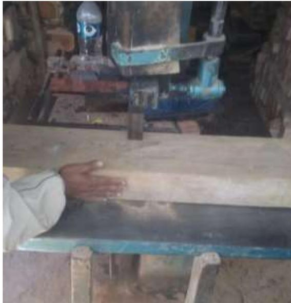
*Figura 14: Laminado de la madera en la sierra sinfín*
