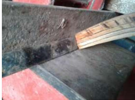
*Figura 35c: Apoyo restringiendo en X y Y*
