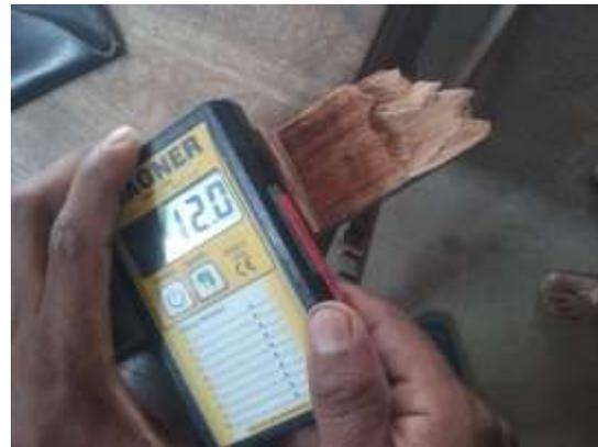
*Figura 24b: Medición del contenido de humedad después del ensayo*
