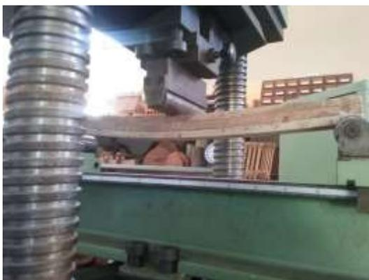
*Figura 27a: ejecución del ensayo de flexión estática*
