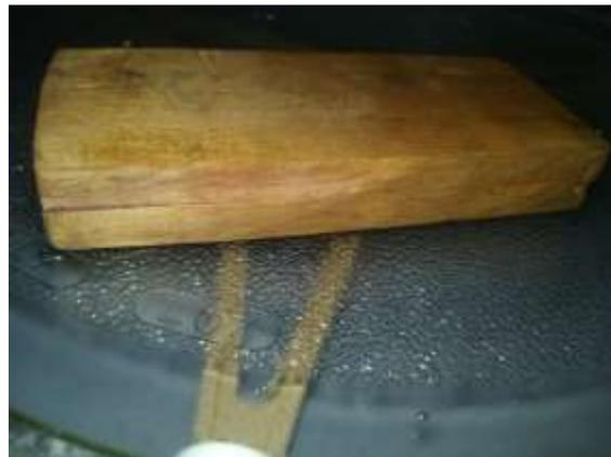
*Figura 13a y 13b: Fotografías de prueba de resistencia del encolado en el microondas.*
