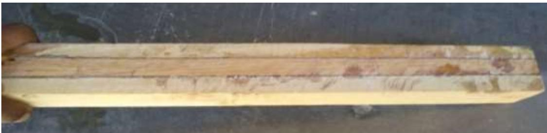
*Figura 23: Probeta para ensayo de flexión estática*
