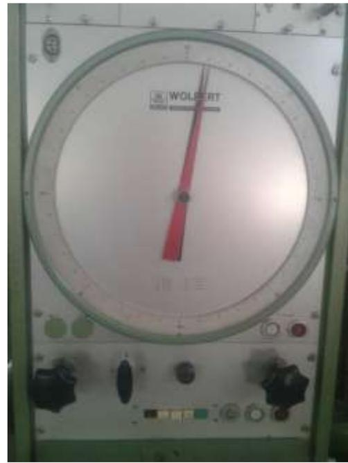
*Figura 25b: Medición del esfuerzo resistente último en la escala de la prensa*
