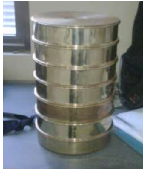
Imagen 3.7 Tamizado y pesado de la arena
