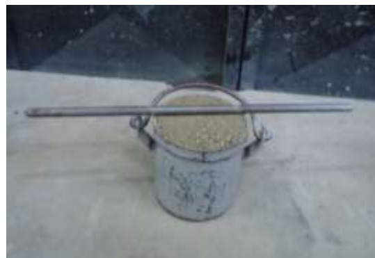
Imagen 3.13 Molde con muestra compactado
