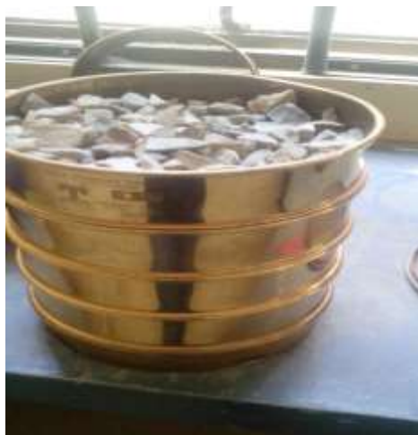
Imagen 3.15 Tamizado y pesado de la grava
