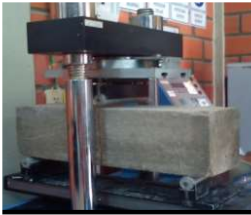
Imagen 3.29 Máquina con carga centrada
