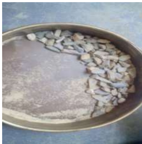
Imagen 3.15 Tamizado y pesado de la grava
