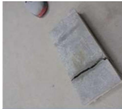
Imagen 3.30 Rotura de vigas
