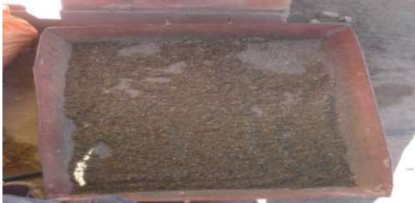
Imagen 3.6 Cuarteo de arena para granulometría
