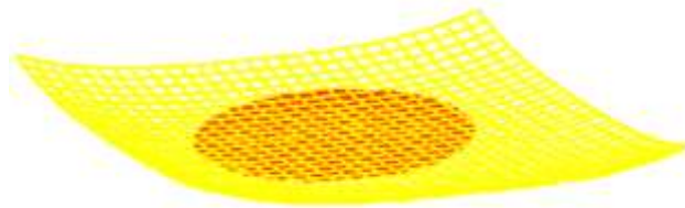
Esquema 2.17 Alabeo medido en una losa de piso industrial
