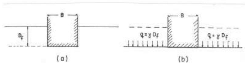
Figura N°2.1 Equivalencia del suelo sobre el nivel de desplante de un cimiento con una sobrecarga debido a su peso
