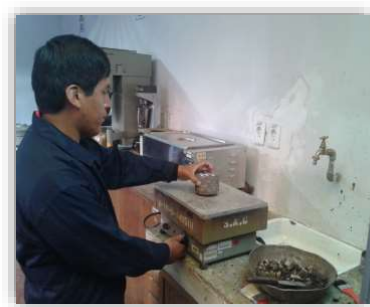
Fotografía 4.4. Calentado del núcleo en una plancha a temperaturas de 60 a 80 °C
