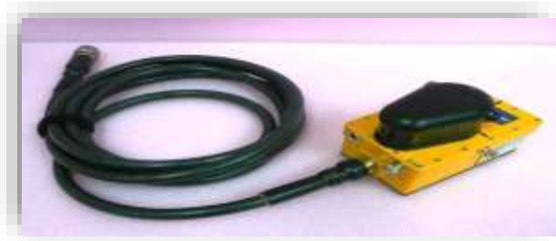
Figura 2.23. Antena de alta frecuencia (2,3Ghz)
