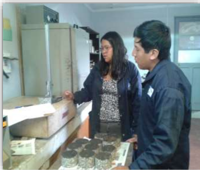
Fotografía 4.7. Mediciones a los núcleos con el vernier
