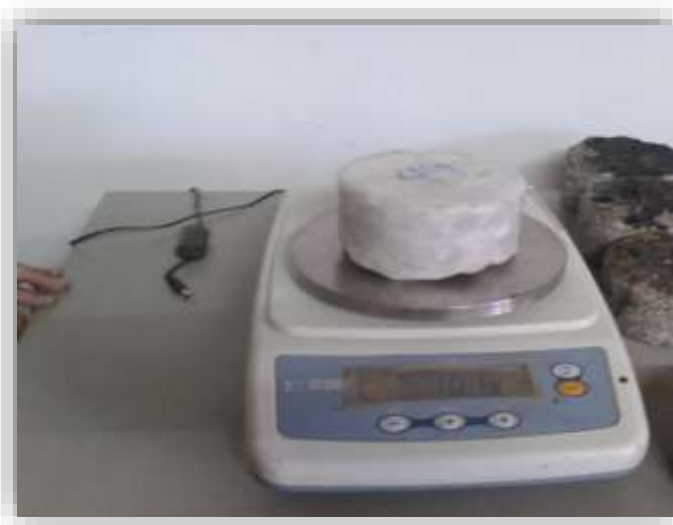
Fotografía 4.12. Pesaje de los núcleos con parafina
