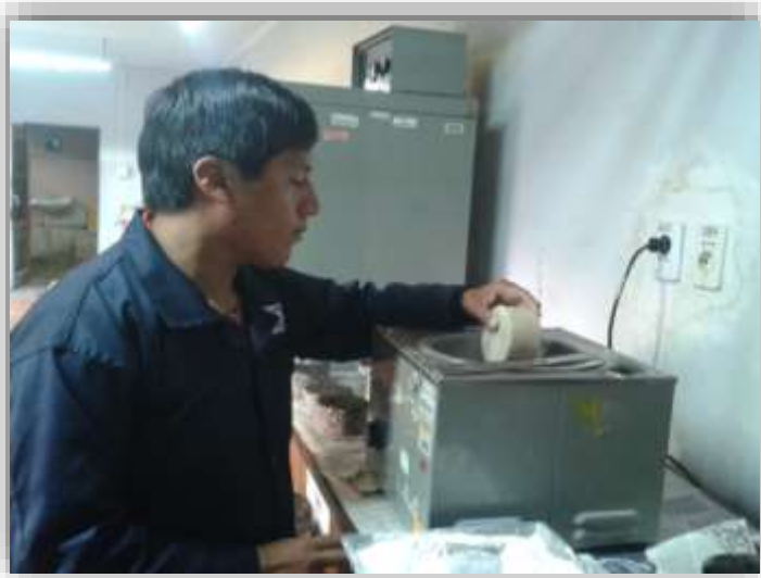
Fotografía 4.10. Confinación del núcleo con parafina cera derretida
