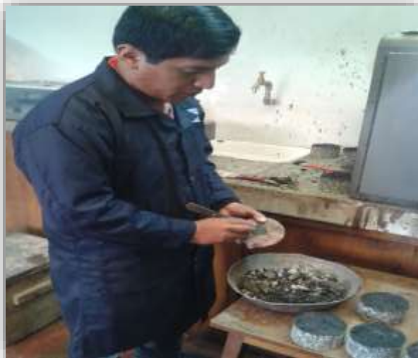
Fotografía 4.5. Desprendimiento de una parte de la capa base después del calentado
