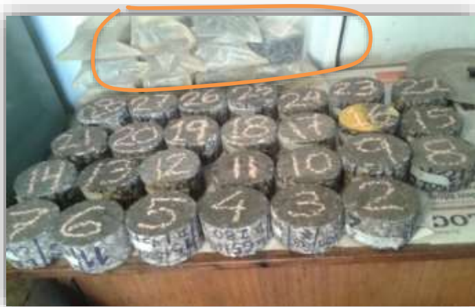
Fotografía 4.2. Núcleos del tramo Uyuni – Cruce Condo K
