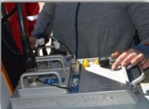
Fotografía 3.14. Conexión de la fuente de energía a la unidad de control
