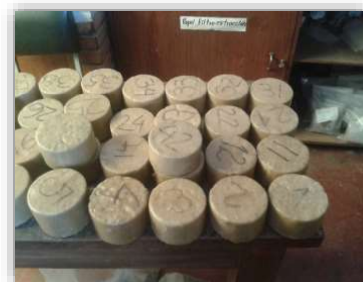
Fotografía 4.11. Colocado de la parafina a los núcleos
