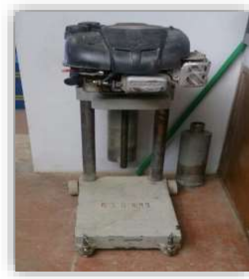
Fotografía 3.1. Extracción de Núcleos en el tramo
