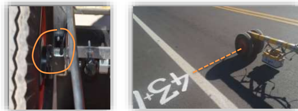
Fotografía 3.22. Ubicación del edómetro con respecto a la progresiva
