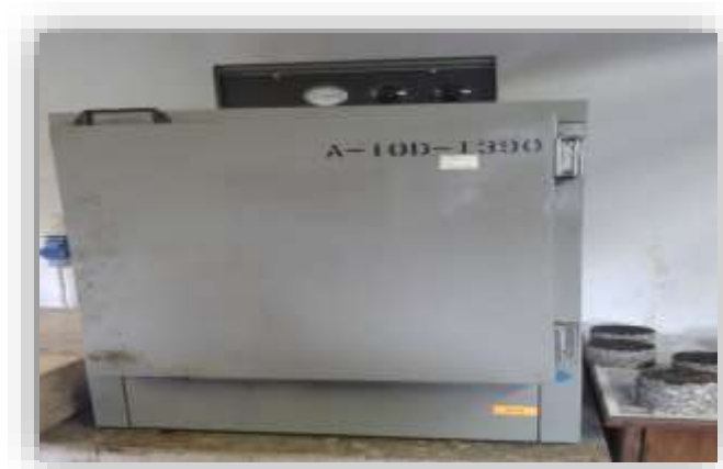
Fotografía 4.15. Horno para el calentado de la muestra
