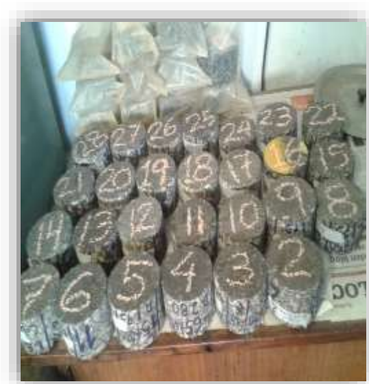
Fotografía 3.2. Núcleos Extraídos del Tramo
