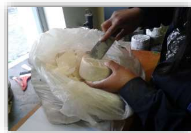
Fotografía 4.14. Retirado de la parafina de los núcleos
