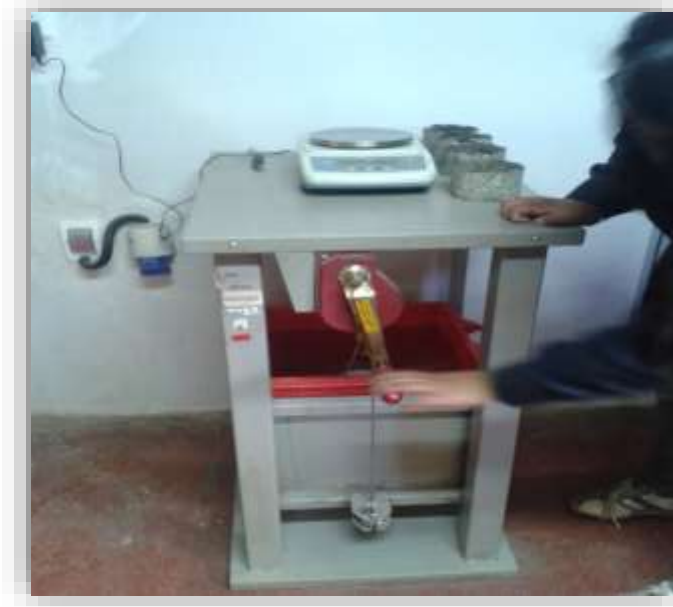
Fotografía 4.13. Pesaje de los núcleos sumergidos en agua
