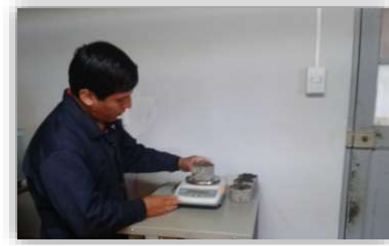
Fotografía 4.8. Pesaje de los núcleos sin recubrir
