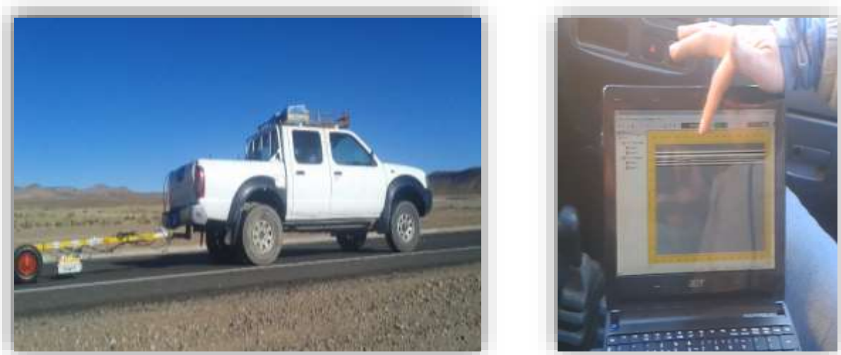
Fotografía 3.27. Vehículo realizando las lecturas con el equipo armado por el tramo de estudio
