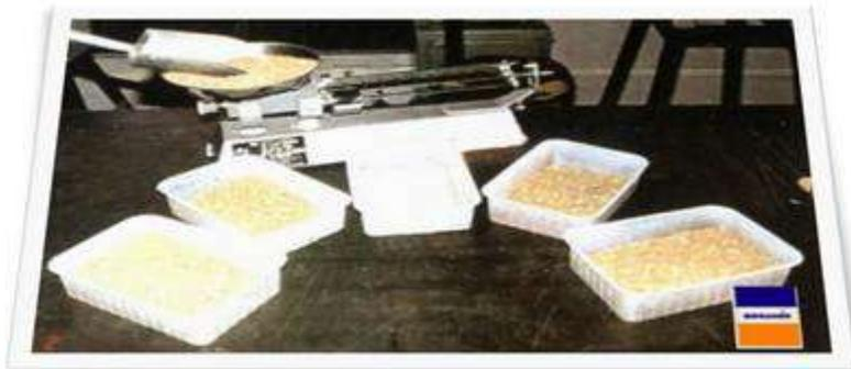
Después, en el laboratorio, con este suelo tamizado y seco, pesar 6 proporciones de XXX gramos para realizar 6 muestras.
