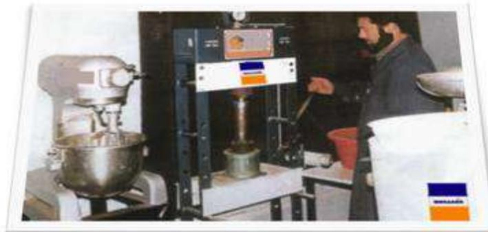
Las 6 muestras, puestas en los moldes, pueden ser comprimidas (50 kg/cm<sup>2</sup>) con una prensa hidráulica (equipamiento como en la foto).
