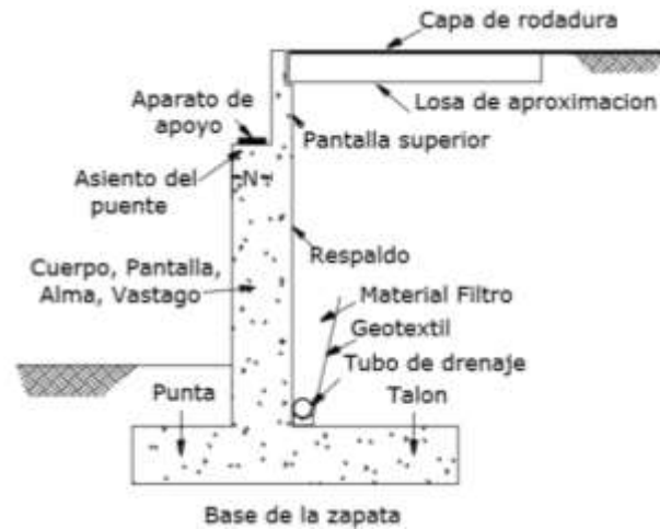
Ilustración 17: Componentes de un estribo
