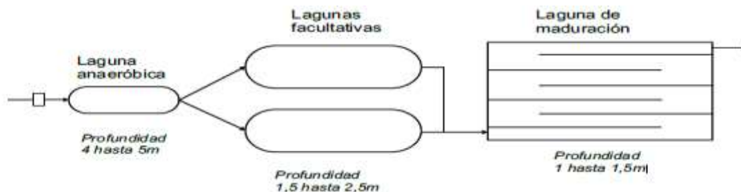
Figura 2.13. Serie de lagunas de estabilización
