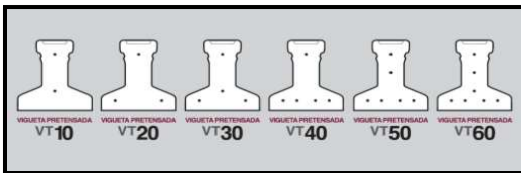
Figura N°33.4 “Sección Tipo de la Vigueta”
