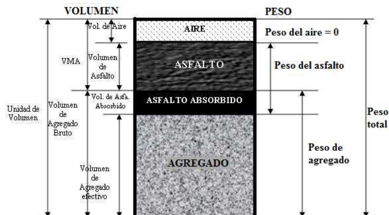
Figura 2.1 Diagrama de componentes de una mezcla asfáltica.
