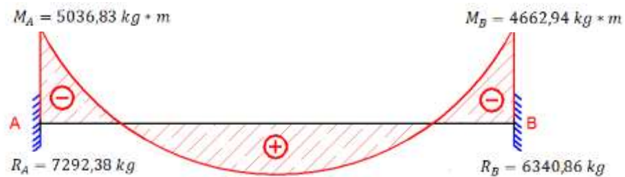
Figura 3.40 Diagrama de momentos de la escalera, como losa plana empotrada.
