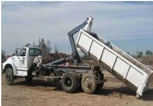
Figura 2.6 Contenedor de escombros y camión con levante hidráulico.
